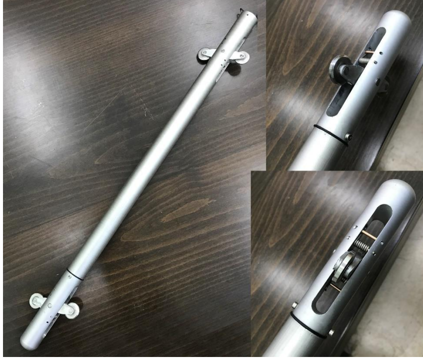
Şekil 8.Üretimi yapılmış nihai tasarım inklinometre probu
