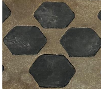
Şekil 7. Hardox500 + Al 2 O 3 Katkılı Neopren Kauçuk aşınma plakasının test sonrası görüntüsü
