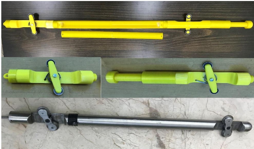
Şekil 7. Plastik ve çelik malzemeden üretimi gerçekleştirilen prototip proplar
