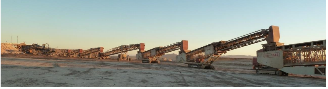
Şekil 14. Şili ACF Gold Altın Madeni yığın liçi uygulaması
