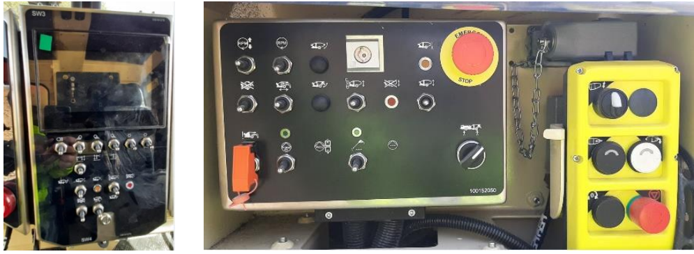
Şekil 4. Kabin içi ve yan gövde tambur kontrol paneli, uzaktan kumanda
