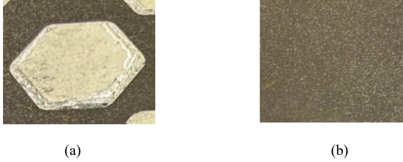
Şekil 6. Hardox500 + Al 2 O 3 kombinasyonundaki (a): Al 2 O 3 , (b): Hardox500 bölgesindeki aşınmanın görüntüsü
