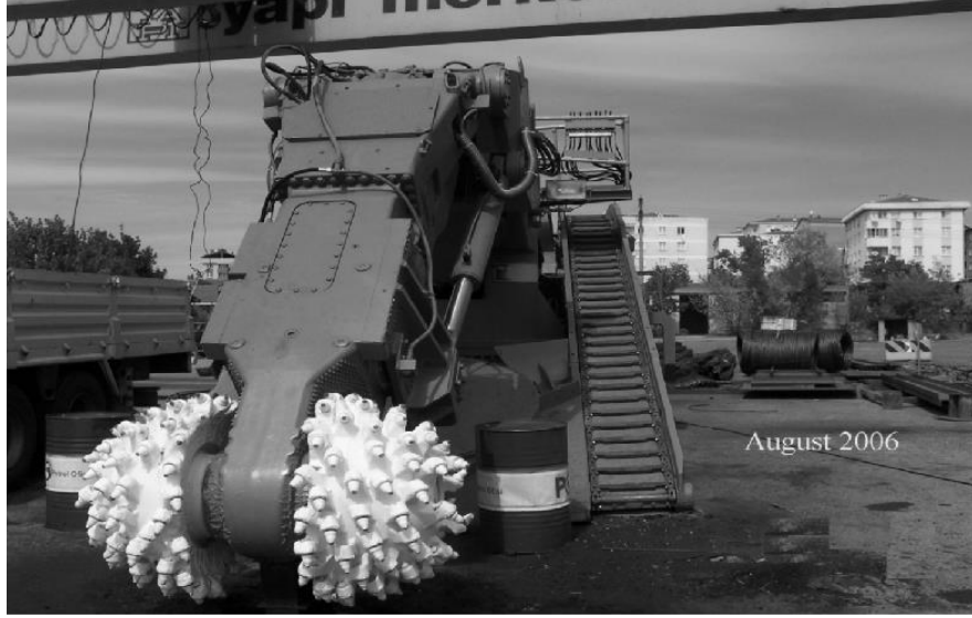
Şekil 1. Kozyatağı-Kadıköy Metro Projesinde istasyon tünellerinde kullanılan transvers tip bir Roadheader (Ocak ve Bilgin, 2010)
