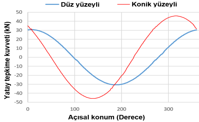
Şekil 7. Düz yüzeyli ve konik şekilli kesici kafalara etkiyen yatay tepkime kuvvet değerinin, kesici kafanın bir dönme hareketi sırasındaki açisal konuma göre değişimi ve büyüklüğü
