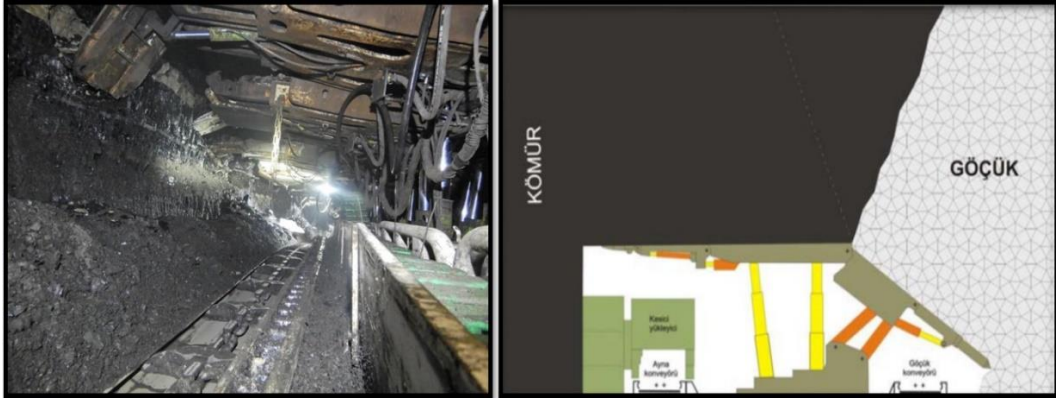
Şekil 5. İşletmede tam mekanize uzun ayakta kömür üretim yöntemi
