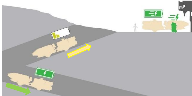
Şekil 5. Ekipman rampa aşağı ve yukarı sürüşlerde şarj durumları
