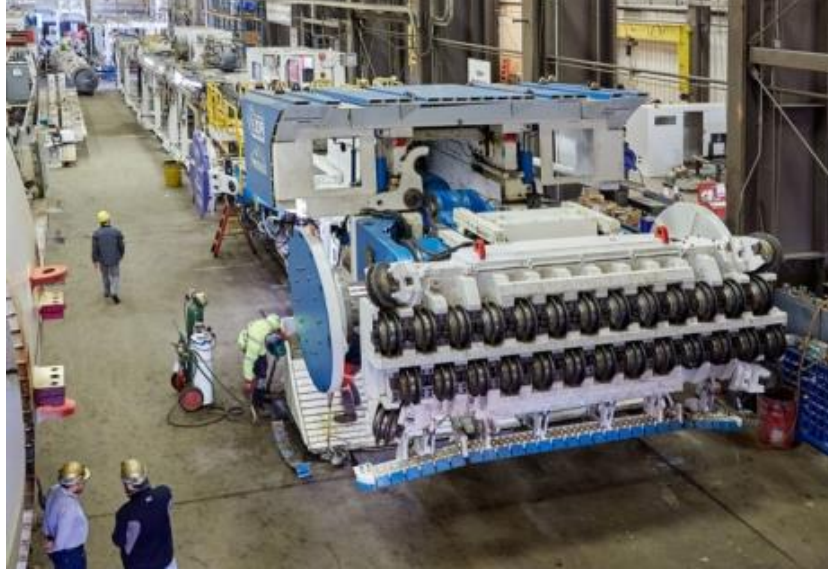
Şekil 8. Fresnillo gümüş madeni için geliştirilen dikdörtgen kesitli galeri açabilen TBM MDM5000
