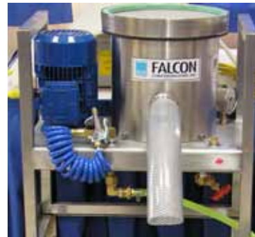
Şekil 1. Laboratuvar ölçekli SB40 model Falcon konsantratörü.
