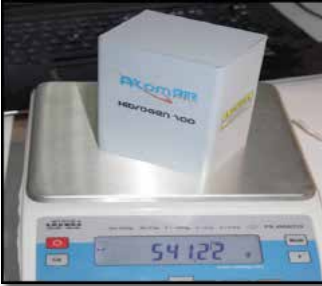
Şekil 7. Sodyum borhidrürlü hidrojen kartuşu prototipi (Hidrojen 100)
