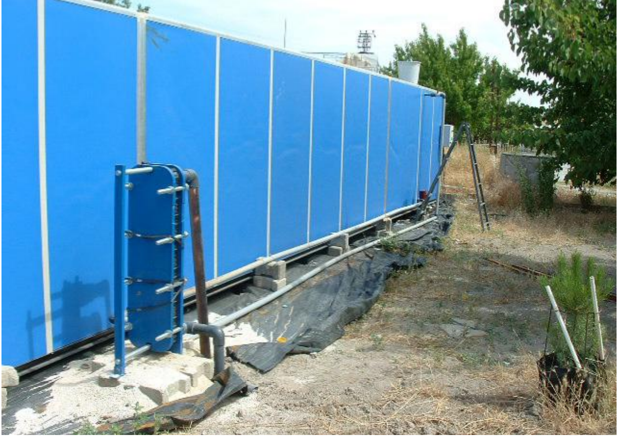
Şekil 2. Jeotermel enerji ile ısıtılmalı kurutma cihazı
