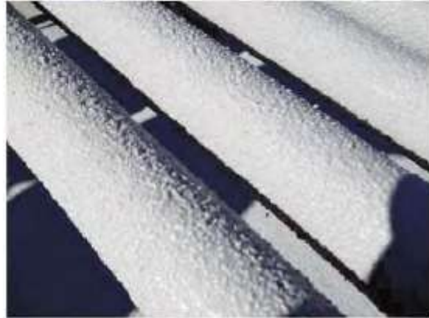
Şekil 7. Poliüre püskürtülerek kaya saplamalarının kaplanması ve kaplanmış saplama yüzeyleri
