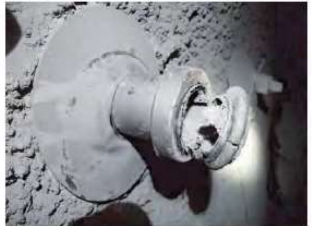
Şekil 9. Çekme testinde kırılmış olan split set
