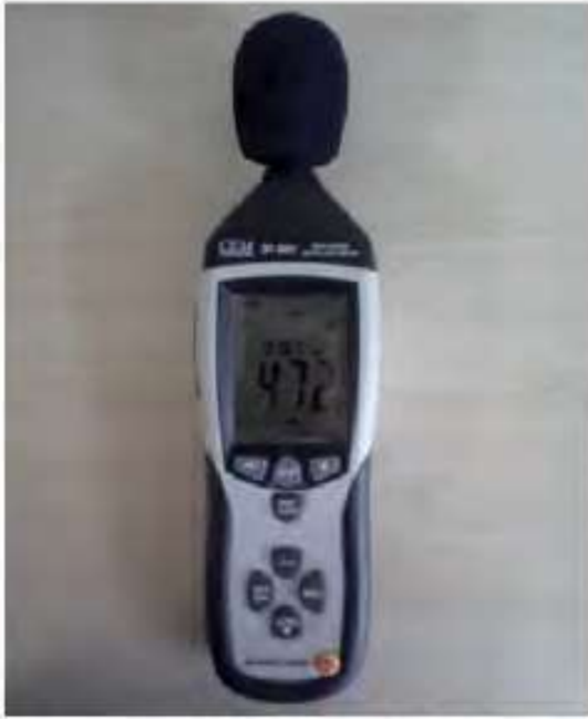
Şekil 10. CEM DT-8852 model gürültü ölçüm cihazı
