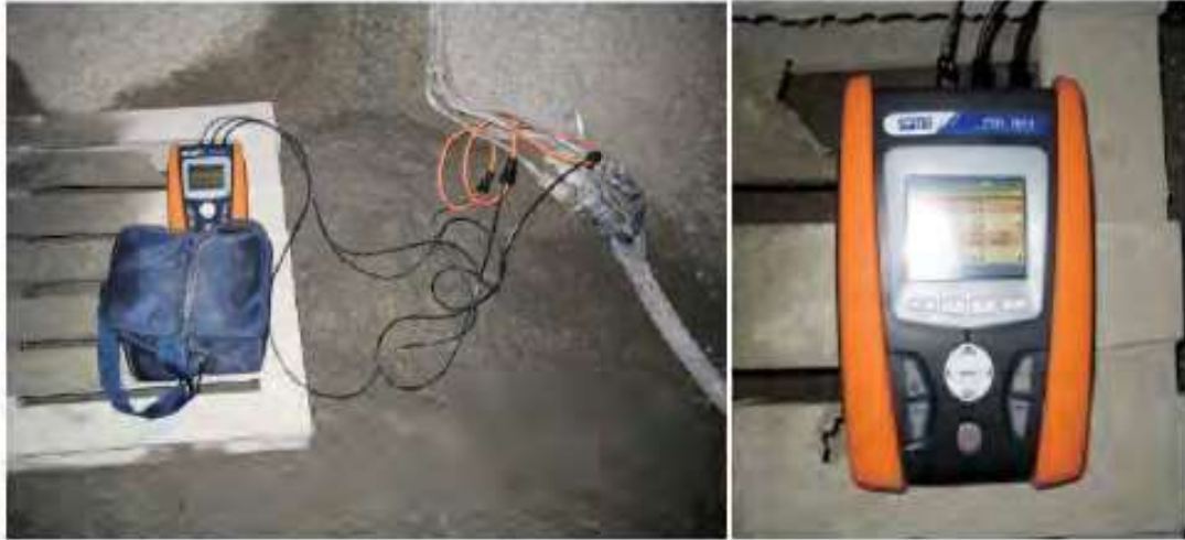
Şekil 3. Spesifik enerji hesaplanmasından kullanılan pensampermetre
