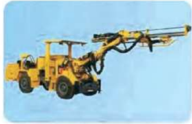
Şekil 2. Yeraltında kullanılan tekerlekli delici (Hidril, 2013)
