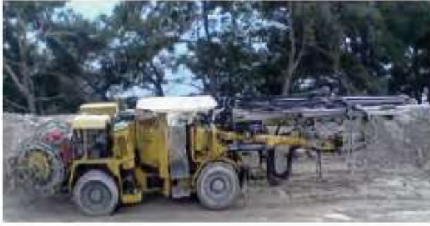
Şekil 4. Atlas Copco Rocket Boomer 282 Jumbo Delici
