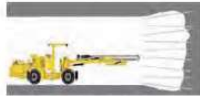
Şekil 12. (a) Direk kontrollü makinalarla delinmiş aynanın patlatma sonrasındaki kesit görünüşü
