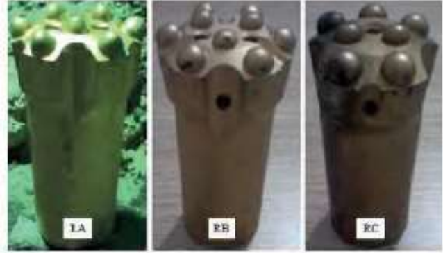
Şekil 6. Delik delme işleminde kullanılan delici uçlar (RA: yarı balistik, konfigürasyon 23; RB: küresel, konfigürasyon 23; RC: küresel, konfigürasyon 06)
