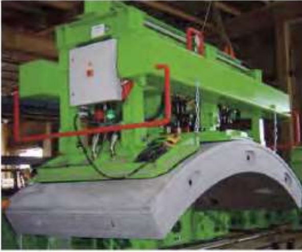
Şekil 1. Kalıptan alınan segment.
