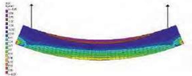
Şekil 10. Statik halde çevirme cihazından alım esnasında oluşan gerilmeler (Bezgin, 2010).
