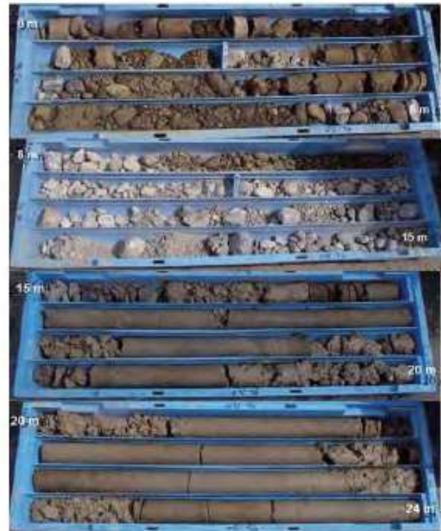
Şekil 5. Tünel güzergâhı üzerinde açılmış bir sondaja ait karotlar (Firma Arşivi)
