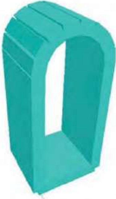
Şekil 7. Tünel yapısal birim modeli (Bezgin, 2012)
