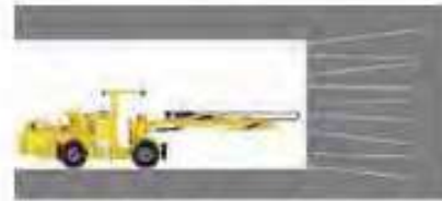
Şekil 11. (a) Direk kontrollü makinalar ile delinmiş ayna kesiti
