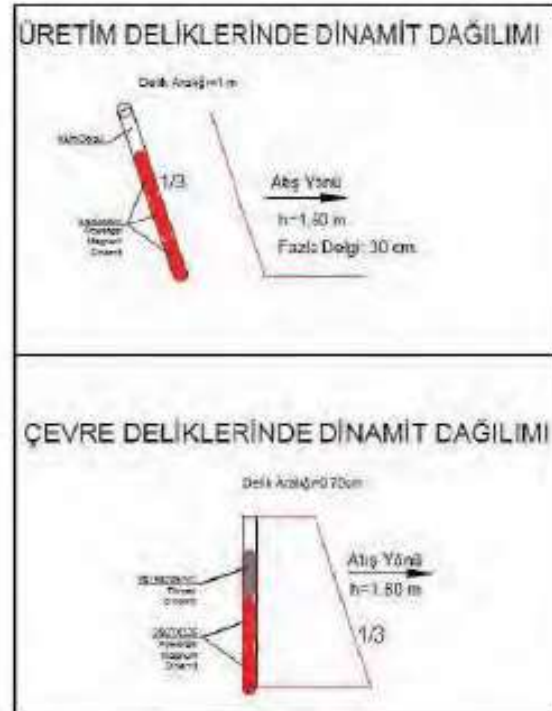
Şekil 7. Üretim ve çevre delik boyu ve dinamit şarjı
