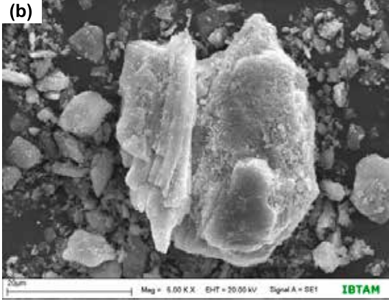
Şekil 9. 20 dakika Öğütülmüş ve (a) 180 ve (b) 240 °C de kalsine Edilmiş Gips Örneklerine Ait SEM Görüntüleri.
