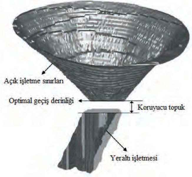
Şekil 1. Açık işletmeden yeraltı işletme modeline optimal geçiş derinliği (Hartman, 2002)
