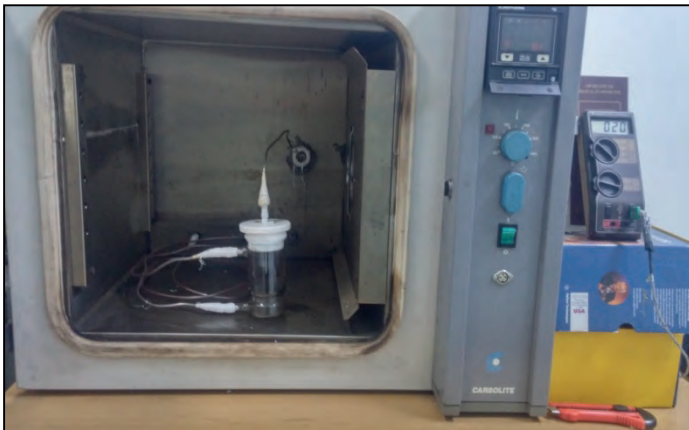
Şekil 3. Tutuşma sıcaklığı deney seti görünümü (Gündoğar, 2016)
