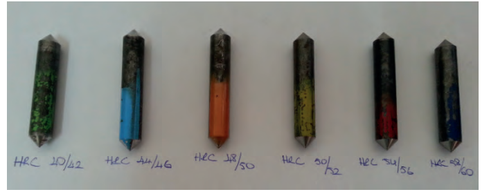
Şekil 5 CAI deneylerinde kullanılan farklı sertlikteki uçlar.
