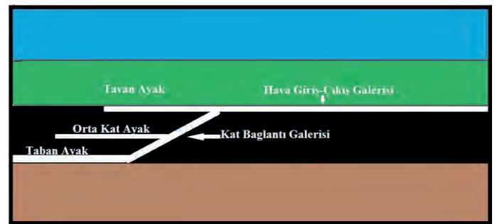
Şekil 3. Soma için önerilen üretim yönteminin kesit görünüşü
