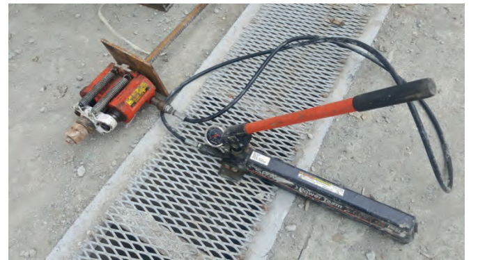
Şekil 2. Tipik saplama çekme testi düzeni
