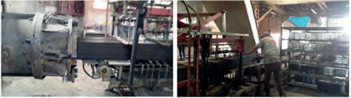
Şekil 1. Üretilen tuğlaların vakum presten çıkışı ve tel kesim ünitesi.
