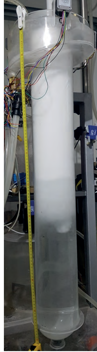
Şekil 8 Jameson flotasyon hücresinin köpük pülp ara yüzeyi ve şamandıra konumu
