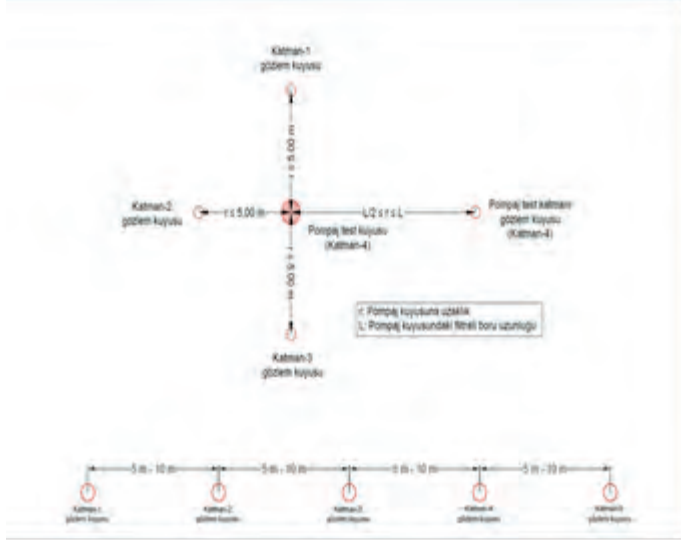
Şekil 4. Pompa test grubu ve uzun dönem gözlem kuyularının kuyu düzeni (Cumhuriyet Üniversitesi, 2015).
