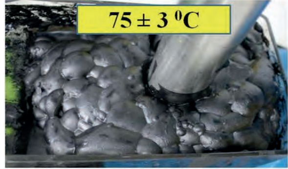
Şekil 4. Düşük ve yüksek sıcaklıkta flotasyon anı görüntüleri
