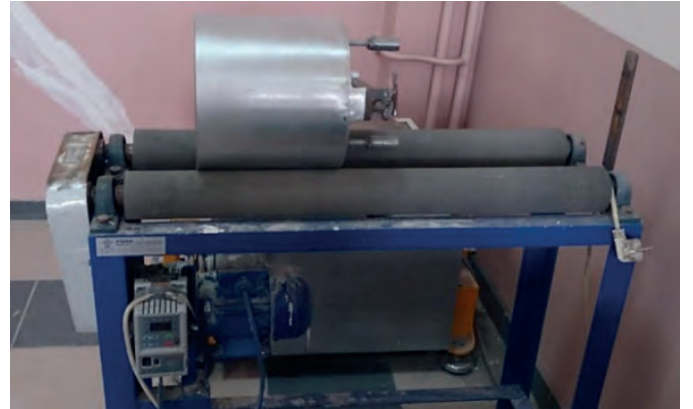
Şekil 2. Deneylerde kullanılan bilyalı değirmen
