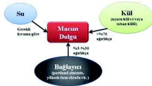
Şekil 1. Uçucu küllü macun dolgu (CIMFR, 2012'den değiştirilmiştir)
