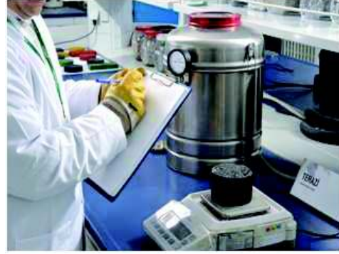
Şekil 4.Suya Hassasiyet Deneyi- Vakumlama
