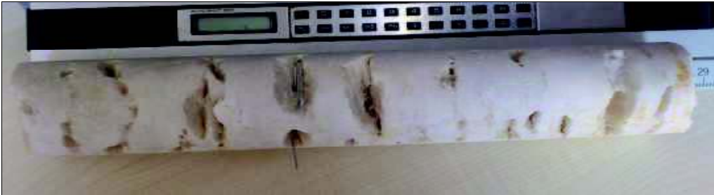
Şekil 4. Yapılan sondajlarda görülen karstlaşmalardan bir örnek
