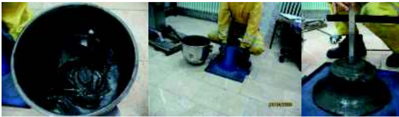
Şekil 2. Macun dolgu kıvamının slamp testi ile ölçülmesi
