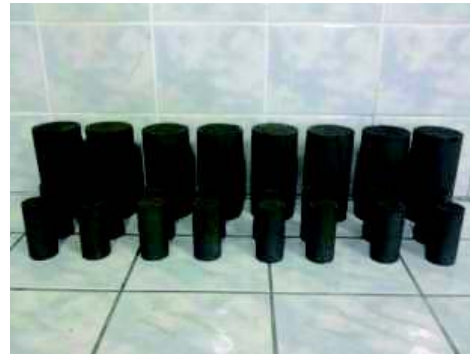
Şekil 2. Farklı boyuttaki (5x10 cm ve 10x20 cm) numunelerin görünümü
