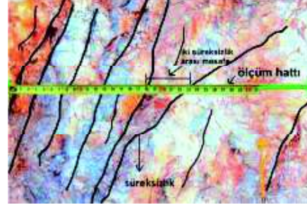
Şekil 1. Bir fotoğraf üzerinde şematik hat etüdü gösterimi.
