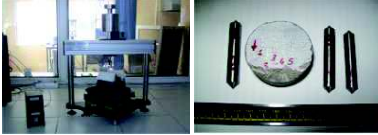
Şekil 6. Cerchar aşınma aleti ve deney sonrası uç görünümü
