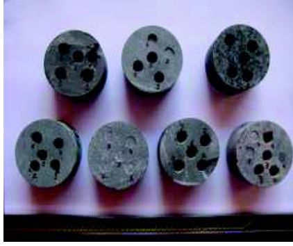
Şekil 9. Sievers minyatür delme deneyinde kullanılan deney örnekleri
