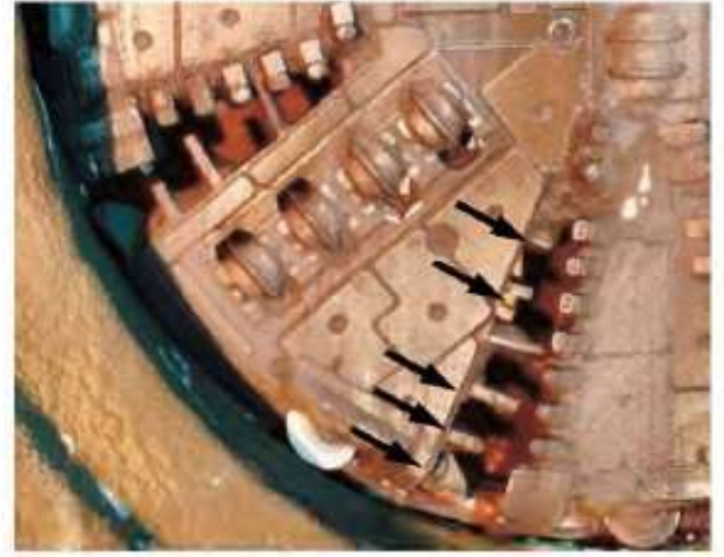
Şekil 4. Kesici kafa kazı açıklığının orijinal durumu ve sac plakalar ile daraltılması
