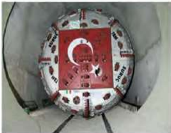
Şekil 3. Suruç Tüneli'nde kullanılan TBM
