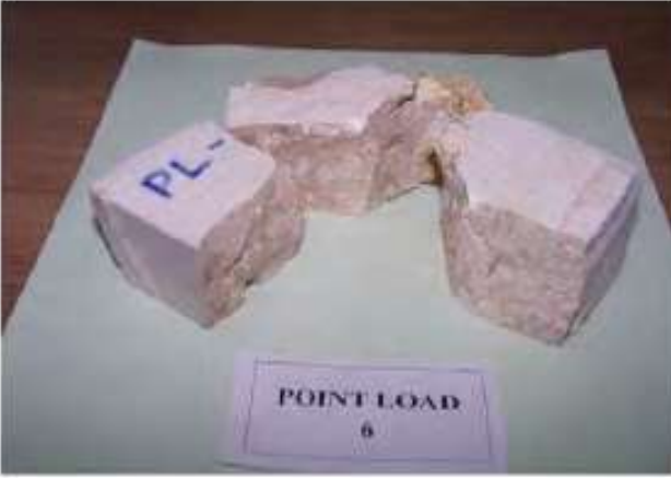
Şekil 7. Güzergahtan alınan numunenin nokta yük dayanım testi sonrası görünüşü
