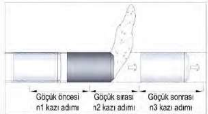
Şekil 8. TBM Kazı parametrelerinin göçük noktasına göre değerlendirme aralıkları
