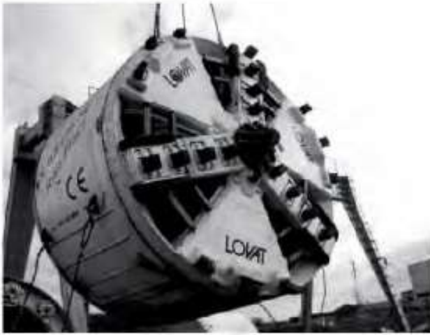
Şekil 2. Kesici kafanın genel görünümü
