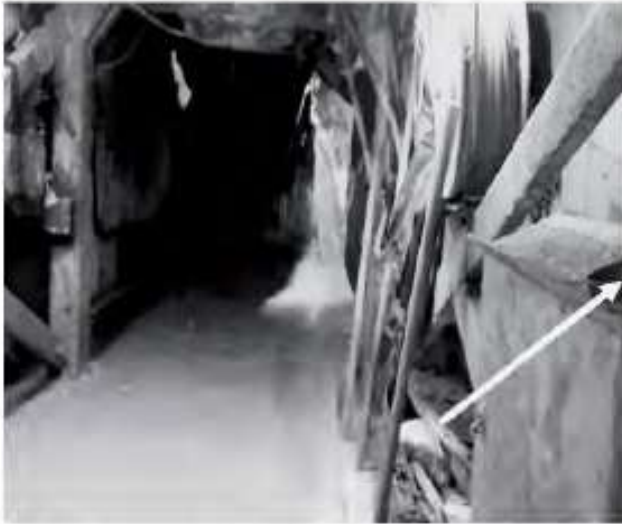
Şekil 5. Aşırı miktarda su ve kum geliri
