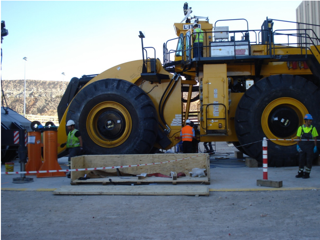
Şekil 1. 21\text{m}^3 kepçeli bir elektrikli yükleyicinin kurulumu (Özdoğan 2013)
