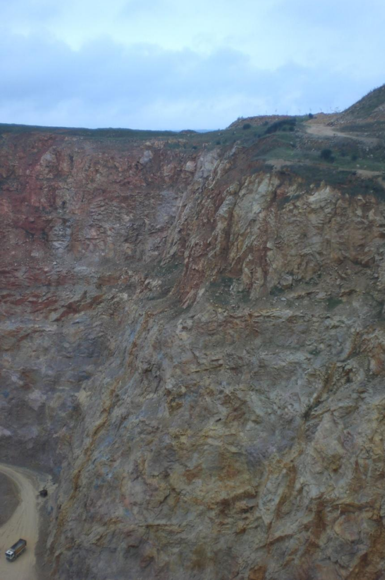
Şekil 7 Yüksek ocak şev açısı ve basamaksız bir işletme
