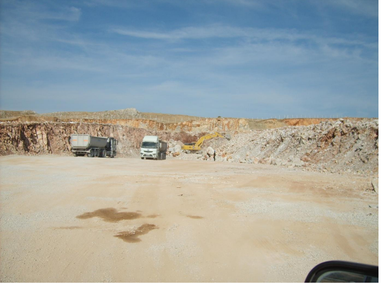
B- Taş ocak işletmesi geometrisi ve düşük yükseklikte kademe basamak yapılması diğer yönden ocak genel şev açısının düşük tutulması
