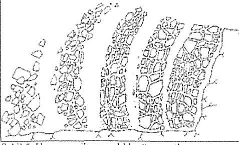
Şekil 5. Uygun gecikme aralıklı yüzey patlatması.
