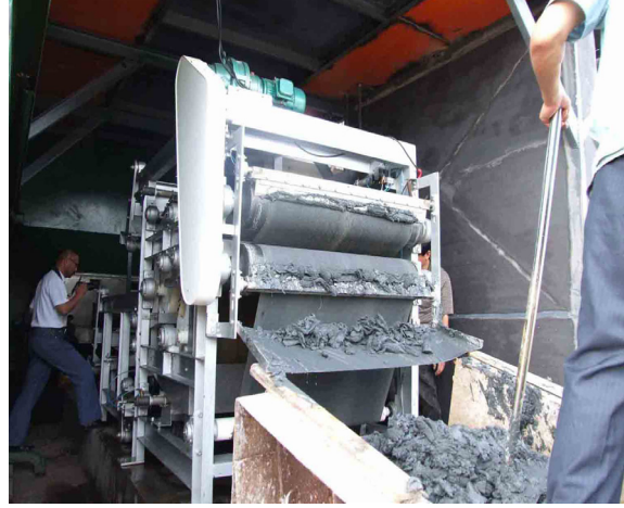
Şekil 12. Bant pres filtresinin görüntüsü
