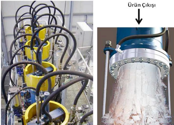
Şekil 15. Tüp tipi pres filtre ve ürün çıkışı
