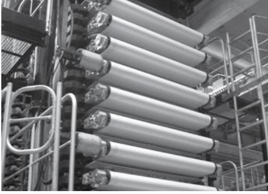
Şekil 14. Membranlı pres filtre
