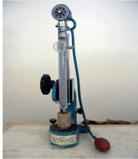
Şekil 3. C-2 tipi Shore skeleroskopu
