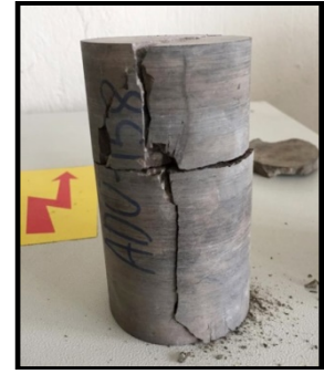
Şekil 5.6. Üç eksenli basınç dayanımı yapılmadan önceki ve sonraki numunenin durumu
