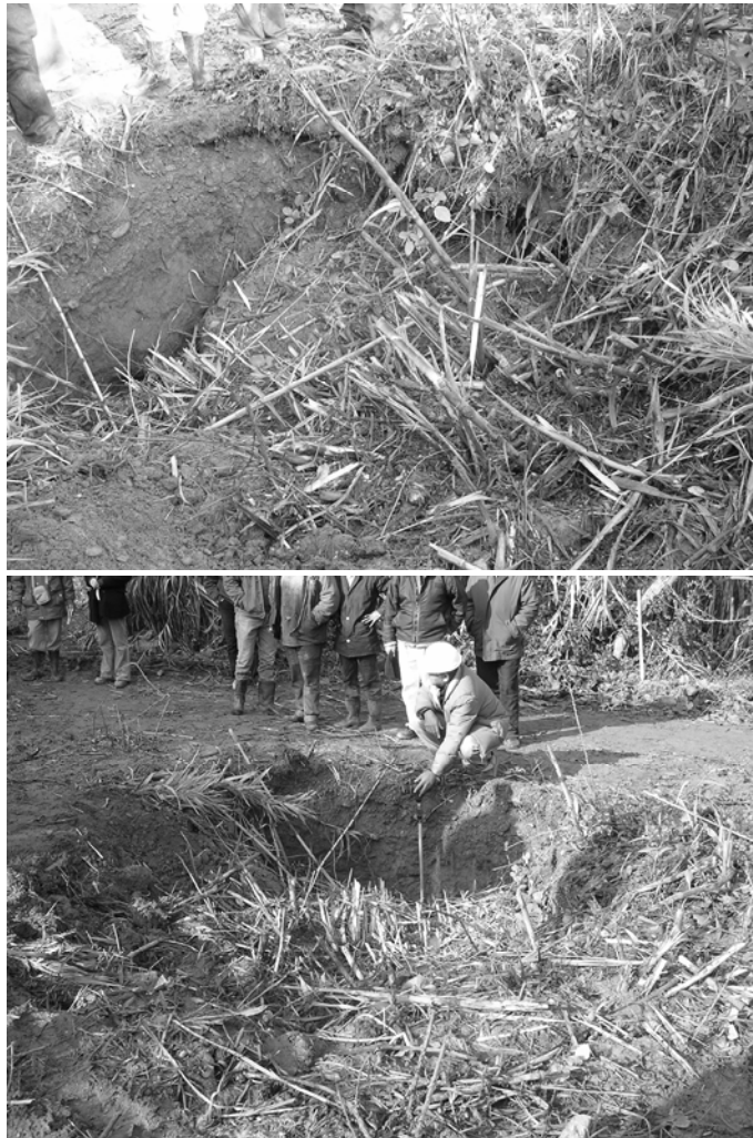
Şekil 3. Aşırı açılmanın yüzeyde oluşturduğu çökmeler.
