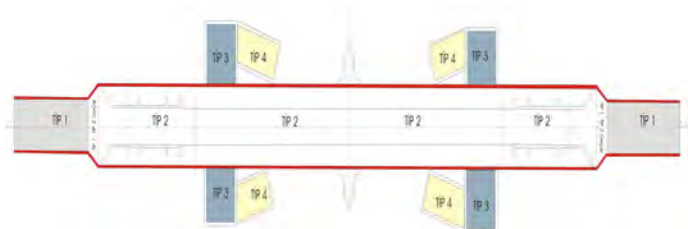
Şekil 2. İstasyon kazılarında planlanan tünel tipleri
