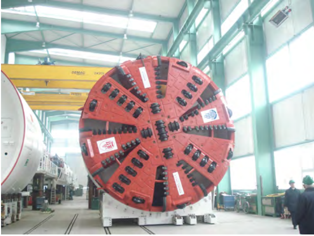
Şekil 3. Lovat EPB-TBM (Sağ Hat)
