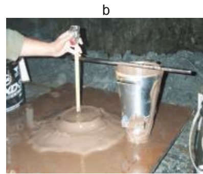
Şekil 2. Macun Kıvam ölçümü
