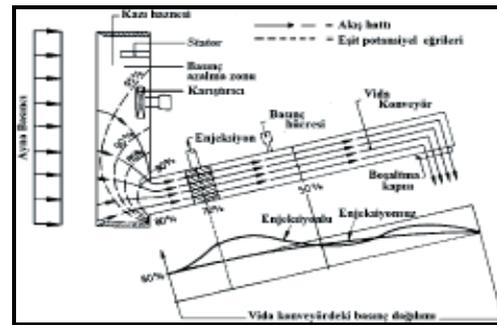
Şekil 2. Bir EPB Makinasında Kazı Haznesindeki Akış Oluşumu (Maidl, 1996)
