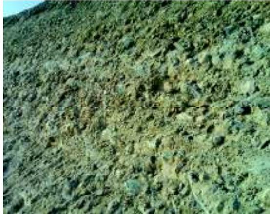
Şekil 4. Kazı alanında gözlenen Killi Kumlu Çakıl birimi (Tünel portal önu istasyon kazısı)
