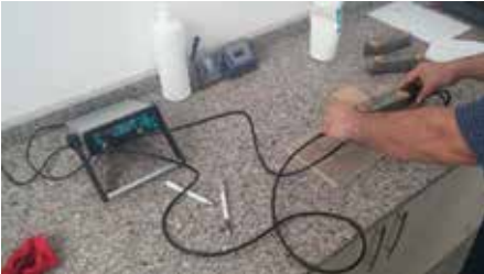
Şekil 4. Ultrases geçiş hızı deneyinin gösterimi
