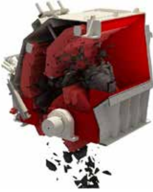
Şekil 4. Darbeli kırıcı çalışma şekli (Metso, 2015)
