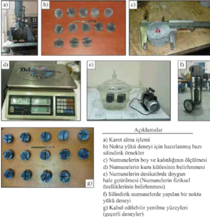
Şekil 4. Düzenli silindirik örneklerde fiziksel özelliklerin belirlenmesi ve eksenel nokta yükü deneyleri.
