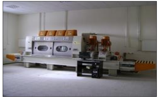
Şekil 3 Toyamer marka bantlı otomatik silim makinası
