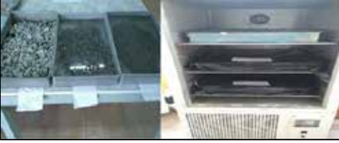
Şekil 7. Donma- çözülme deneyi
