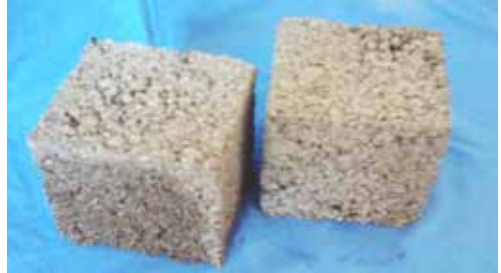
Şekil 3. Hazırlana kuru karışım hafif beton örnekleri genel görünümü.
