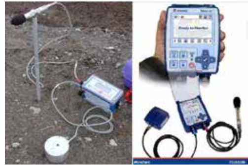
Şekil 5. InstanTEL Minimate Blaster model ve InstanTEL Micromate model titreşim (yer sarsıntısı) ve hava şoku ölçüm cihazları
