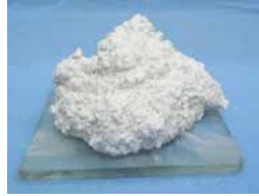
Şekil 4. Taze harç formda yüksek oranda iri boyutlu diyatomit hafif harç.
