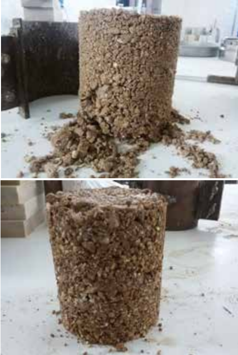
Şekil 14. Sıkıştırılmış granüler malzemelerin optimum su içeriklerinde sıkıştırılmaları sonrası görünümleri (üstte, ince taneli taş unu ve altta, ince taneli kil olan karışım görülmektedir).
