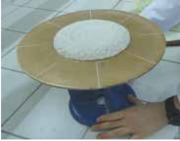
Şekil 3. Taze harcın akma tablasındaki yayılma durumu.
