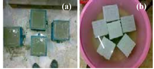
Şekil 2. Beton numunelerinin kalıplara doldurulması (a) ve suda kür işlemi (b)
