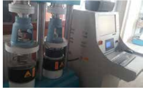
Şekil 5. Eğilme dayanımı deneyi düzeneği
