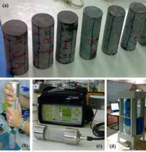
Şekil 2. Alınan karotların (a), SHV testinin (b) UPV testinin (c) ve TEBD ünitesinin (d) görünümü
