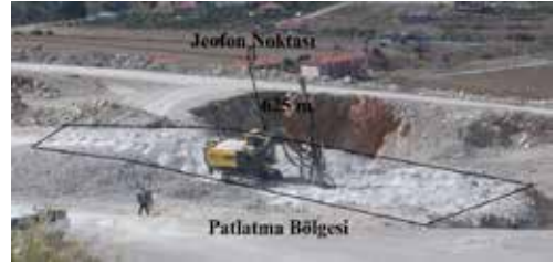
Şekil 4. Ocak içerisinde delici makinenin patlatma deliklerini delerken görüntüsü
