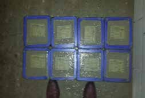
Şekil 4. Taze betonun küp kalıplara yerleştirilmesi
