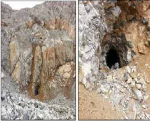
Şekil-2: Galerinin atımı için açılmış olan boşluk
