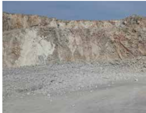
Şekil 16. Elektronik kapsüller ile yapılan patlatmada elde edilen patlatılmış ürün görünümü
