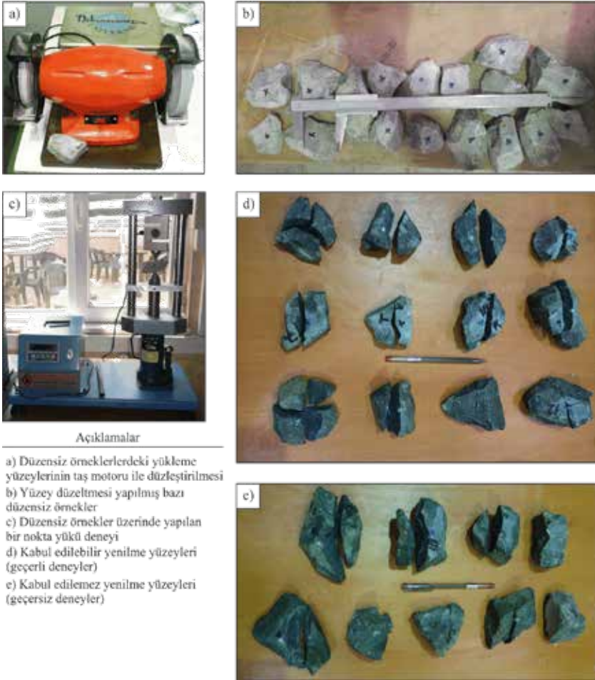
Şekil 5. Düzensiz şekilli agregalar üzerinde gerçekleştirilen nokta yükü deneyleri.
