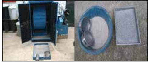
Şekil 9. Los Angeles deney düzeneği
