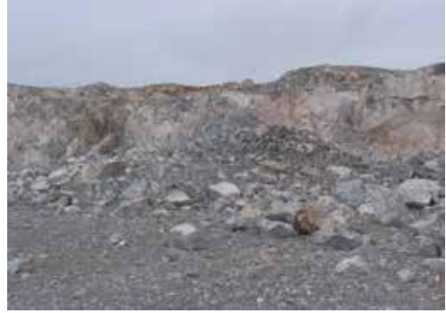
Şekil 15 Elektriksiz kapsüller ile yapılan patlatmada elde edilen patlatılmış ürün görünümü
