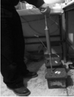
Şekil 1. Taze harçlarda priz süresi ölçümü
