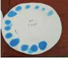
Şekil 1. 601 Kumunu metilen süzgeç kağıdı
