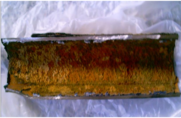
Şekil 1. İç korozyona uğrayan izolasyonlu şehir şebeke gidiş borusunun fotoğrafı
