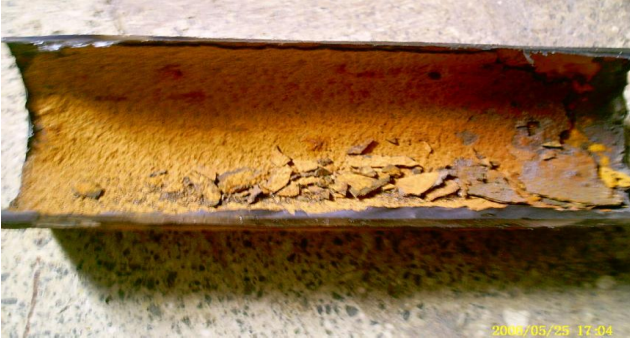
Şekil 1. İç korozyona uğrayan izolasyonlu şehir şebeke gidiş borusunun fotoğrafı
