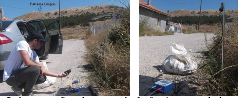
Şekil 3. Patlatma ve Güneybatı yönünde Jeofon istasyon noktalarının GPS ile belirlenmesi
