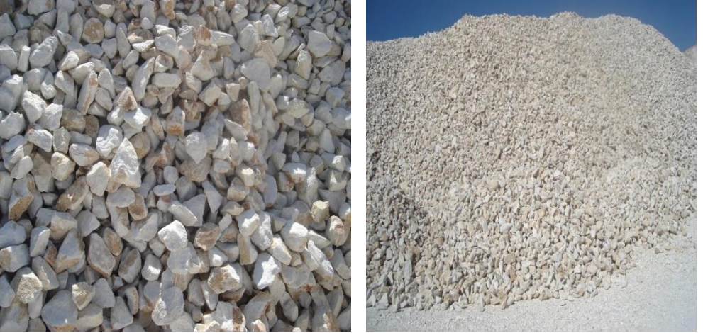
Şekil 1. Triyajatabi tutulmak üzere kırılmış kalsit cevheri ve el ile triyaj sonrası oluşan artık
