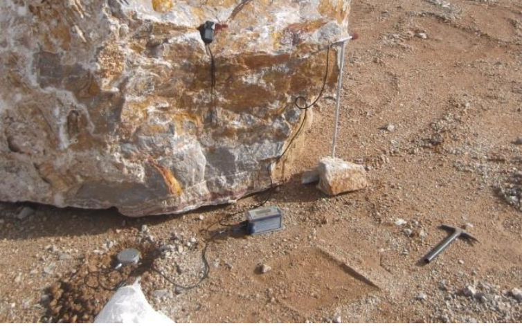
Şekil 6. Jeofon istasyon noktalarının GPS ile belirlenmesi
