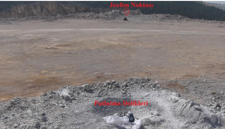
Şekil 5. Patlatma ve Jeofon noktalarının GPS ile belirlenmesi
