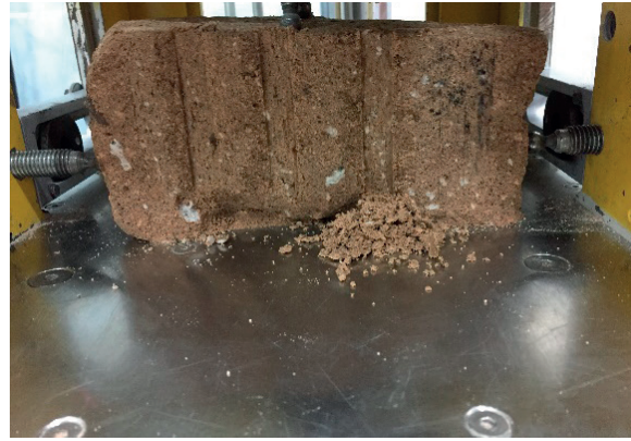
Şekil 6. Kristal tüf numunesinin kesme deneyine tabi tutulması
