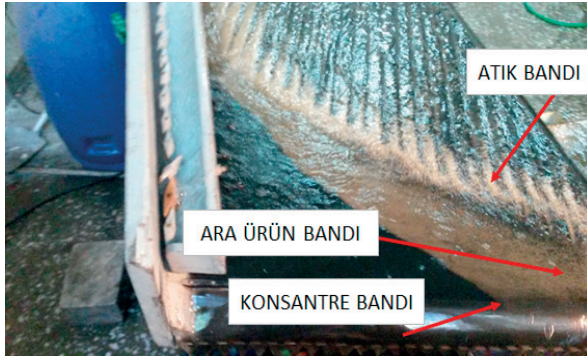
Fotoğraf 1. Sallantılı masa testine ait görüntü
