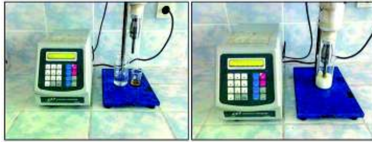
Şekil 2. Atık yağın ses ötesi dalgalar ile emülsiyeye edilmesi
