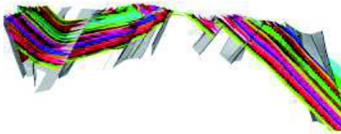
Şekil 6. Fay ve kömür damarlarının görünümü
