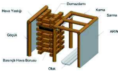
Şekil 12. Ayak tahkimatının görünümü
