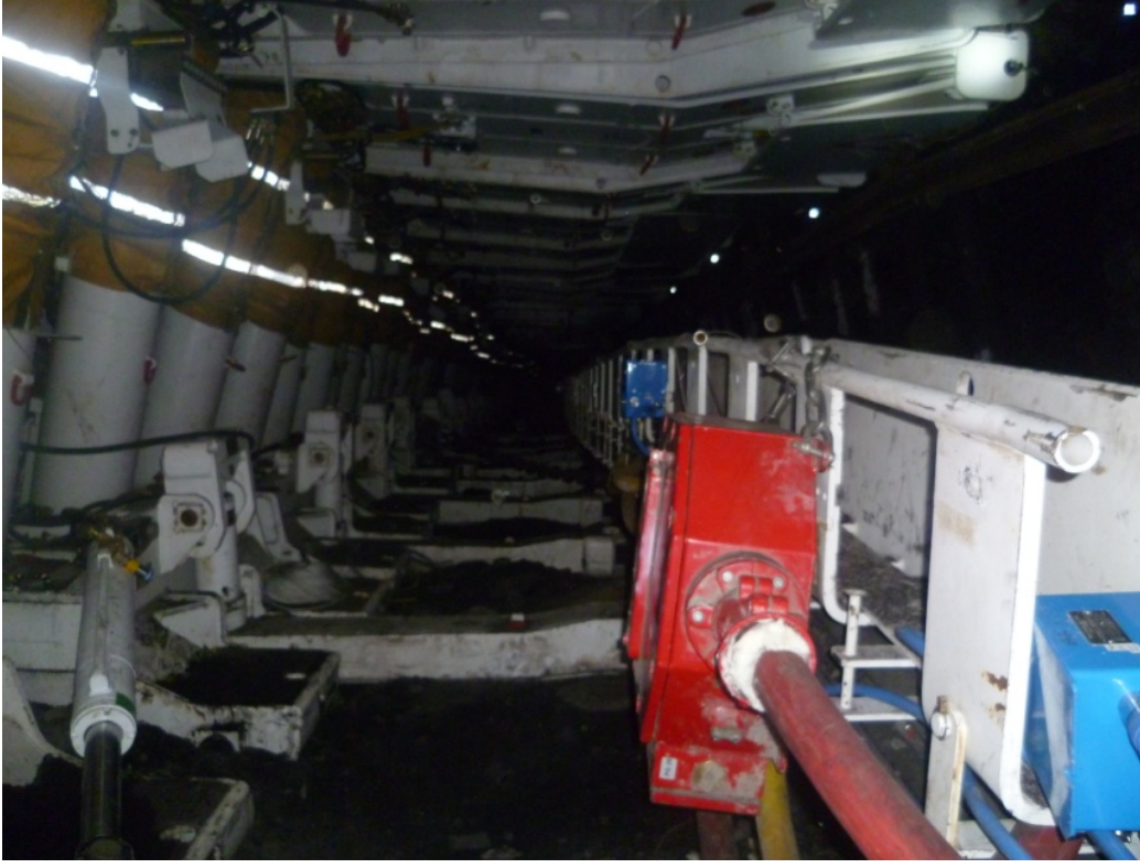
Resim 1.Eynez Doğu ocağından tam mekanize sistem ayak içinden görünüm.[15]
