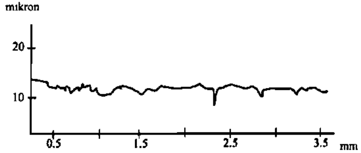
Şekil 2. Bej grubu mermer türüne ait yüzey pürüzlülük profili.
