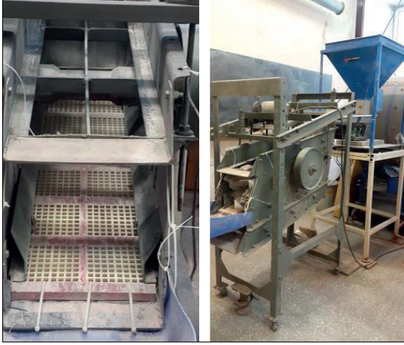
Şekil 4. Pilot ölçekli elek ve besleme sistemi
