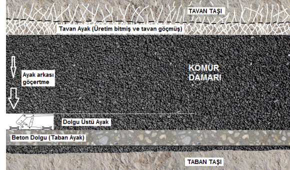
Şekil 9. Dolgu üzeri ana üretim ayağının şematik gösterimi (Ünver vd., 2015)
