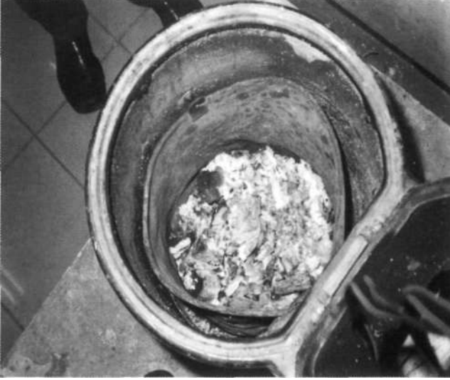
Fotoğraf 4. Briketlerin Yakılması Sonucu Oluşan Yanma Kamarası
