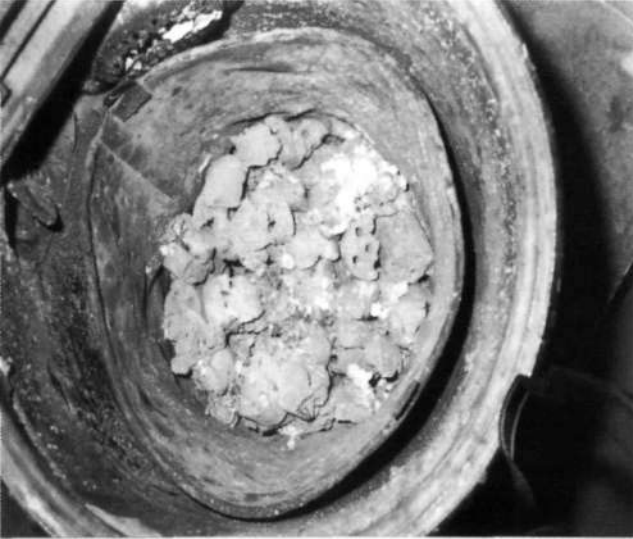
Fotoğraf 4. Briketlerin Yakılması Sonucu Oluşan Yanma Kamarası
