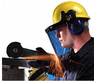
Şekil 5. Metal kesme işi için tasarlanmış bir baret örneği (OSHA, 2008)
