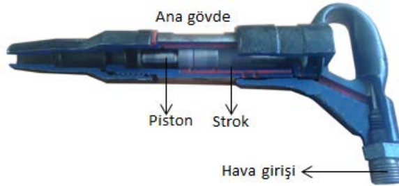
Şekil 2. Martopikörde gürültüye neden olan piston ve ana gövdesi
