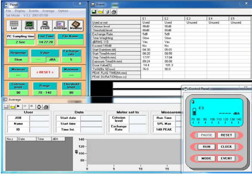
Şekil 2. Extech 407355 Kişisel gürültü dosimetresinin bilgisayar ekran çıktısı
