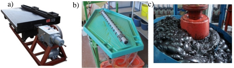
Şekil 6. Fiziksel zenginleştirme metotlarından sallantılı masa (a) ve Gemini masası (b) ile fiziko-kimyasal flotasyon işleminde reaktiflerce oluşturulan köpükler (c).
