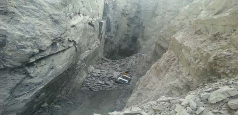
Şekil 5. Açık işletme ocağında şevlerin dikliği (Irgat, 2015)
