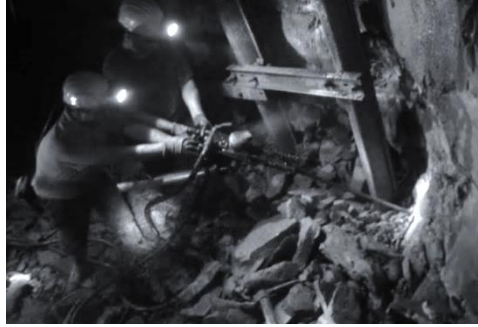
Şekil 3. Martoperfaratör ile arında delik delerken işçilerin gürültüye maruziyeti
