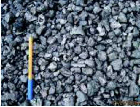
Şekil 9. Jig ile geri kazanılmış FeCr
