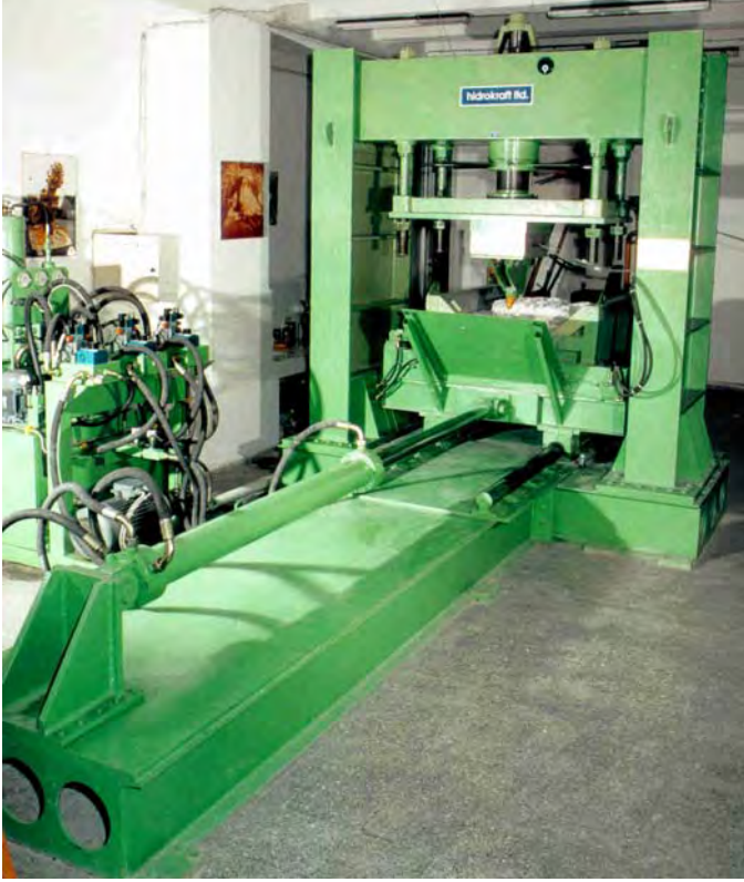
Şekil 7. Tam Boyutlu Kesme Deney Seti
