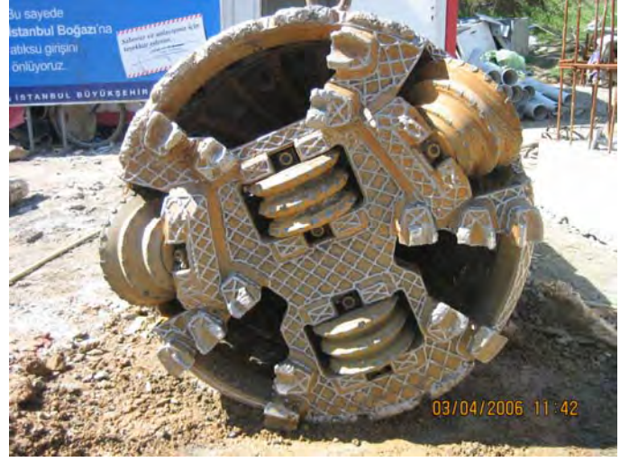
Şekil 11. Herrenknecht AVN 600 Mikrotünel Makinesi Kesici Kafası
