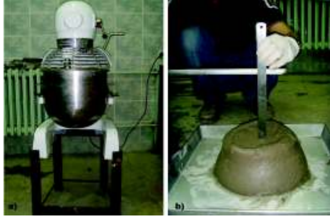
Şekil 2. Dolgu malzemeleri karıştırıcısı (a), çökme değeri ölçümü (b).
