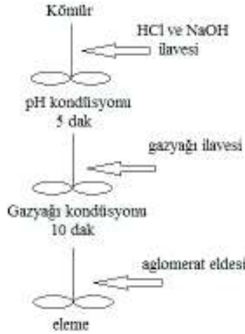
Şekil 1. Yağ aglomerasyonu deneylerinde izlenen akım şeması.
