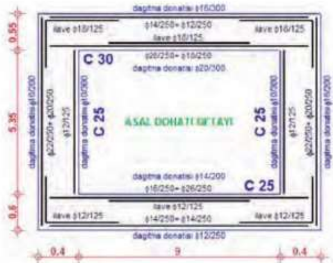
Şekil 9. Yapay Arı Koloni Algoritmasıyla belirlenen asal donatılar için optimum enkesit detayı
