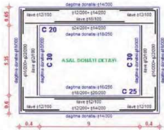
Şekil 11. Genetik Algoritmayla belirlenen asal donatılar için optimum enkesit detayı
