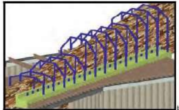
Şekil 33. Kazı-kazık ve kafes sistemi projelendirilmesi
