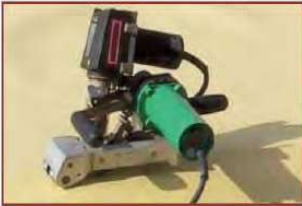
Şekil 7. PVC su tutucu kaynak uygulaması
