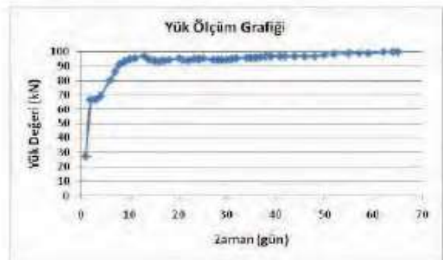
Şekil 10. Yük Hücresi-4'e ait ilerleme eş zamanlı kaya yükü-tahkimat yükü grafiği
