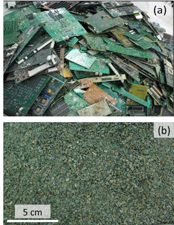
Şekil 3. (a) Baskılı devre kartları ayrılmış AEEE; (b) İki kademeli boyut küçültme uygulanmış ABDK (-3,35 mm)
