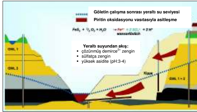
Şekil 8. Kömür açık işletmelerinde yeraltı suyu etkileşimi (Zschiedrich 2012).
