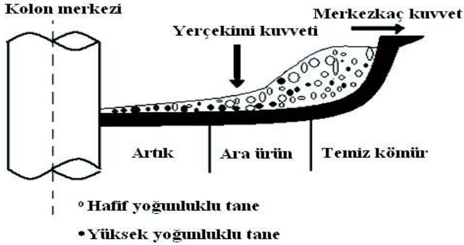
Şekil 2. Spiral ayırıcı şematik kesit görünüşü (Zhang 2008).
