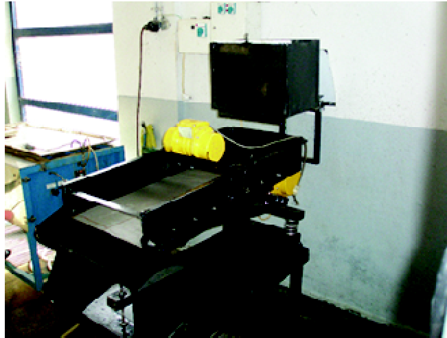
Şekil 1. Yüksek frekanslı titreşimli susuzlandırma eleği.
