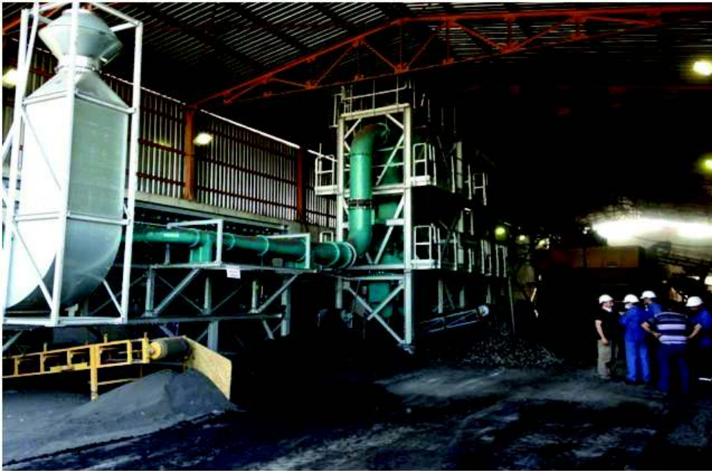
Şekil 4. ELİ Soma’da kurulan 15-20 ton/saat kapasiteli Allair Jigi.
