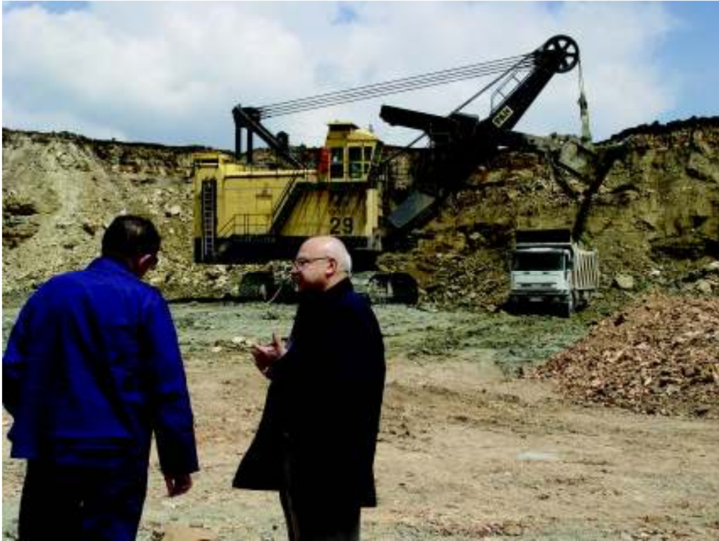
Şekil 3. Karayolu taşıtını yükleyen 8 m 3 kepçeli bir elektrikli kazıcı (Özdoğan 2006).
