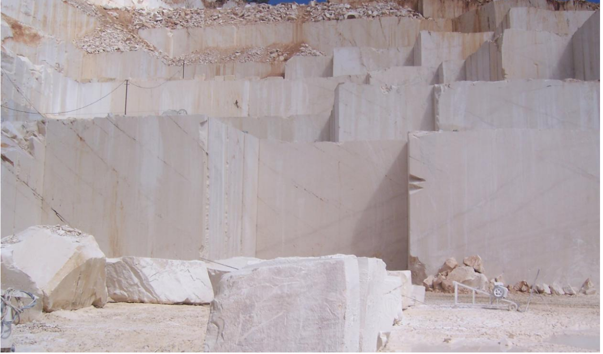
Şekil 44. Süreksizliklerin göz önüne alınmadığı bir ocak işletmesi örneği
