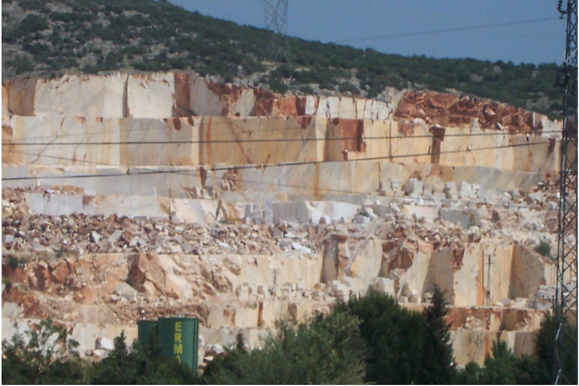
Şekil 13. Yamaç tipi açık ocak doğal taş işletmesi (Muğla)
