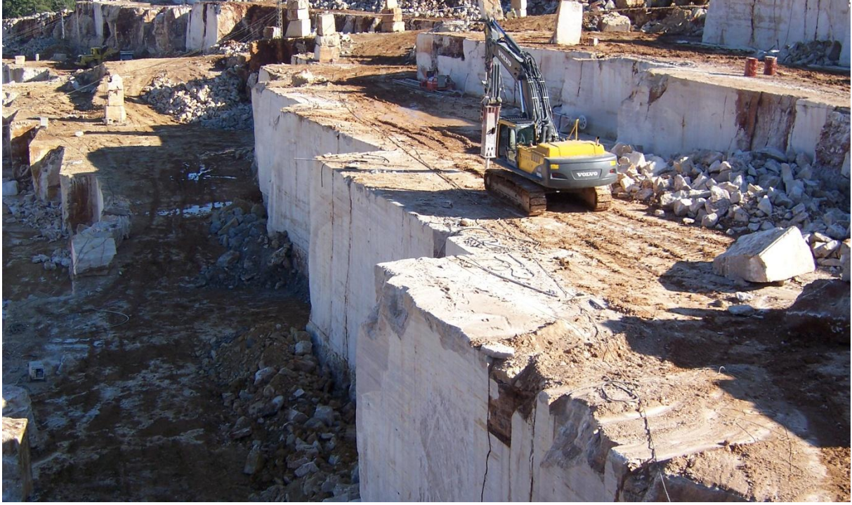
Şekil 32-a. Bir doğal taş ocağında basamak yüksekliklerinin görünümü (BUCAK PORTSAN A.Ş.)
