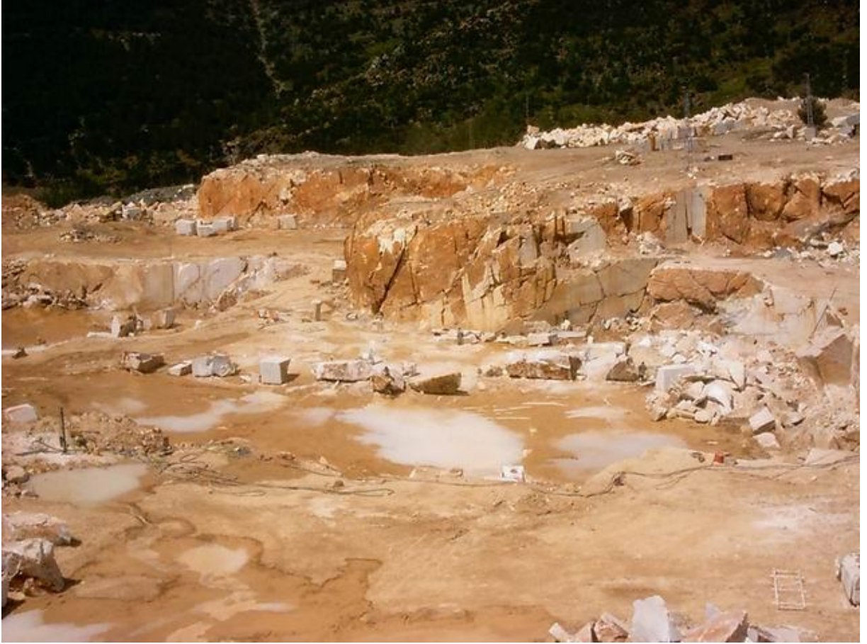
Şekil 11. Tepe tipi açık ocak doğal taş işletmesi (Muğla)
