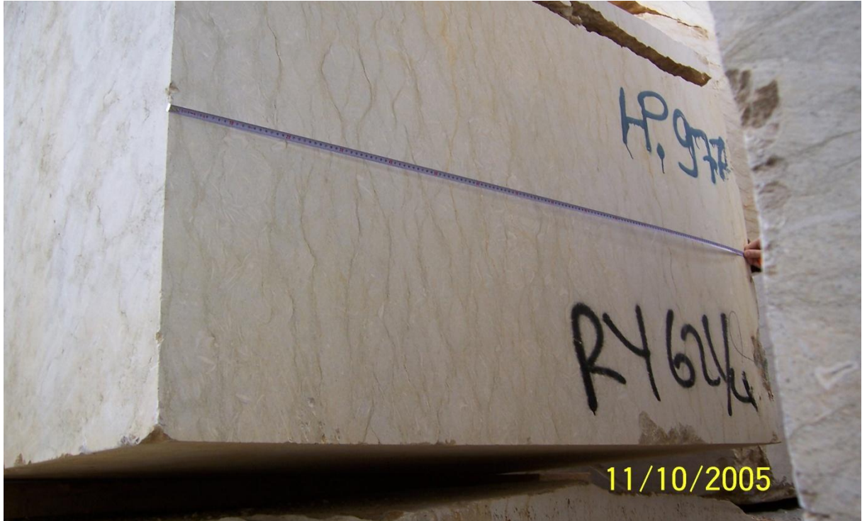
Şekil 26. Deformasyon geçirmiş dalgalı yazıtlı (stilolitik) sparitleşmiş mikritik kireçtaşı
