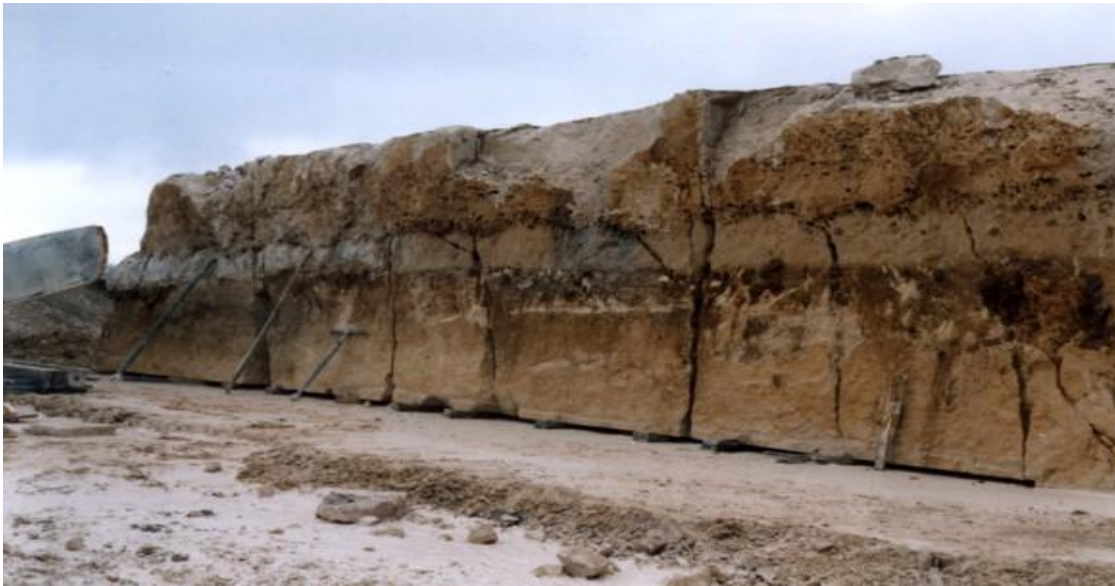
Şekil 48 Yapısal jeoloji elemanlarından yararlanılarak uygun kesme makinesi meçimi ve blok üretimi
