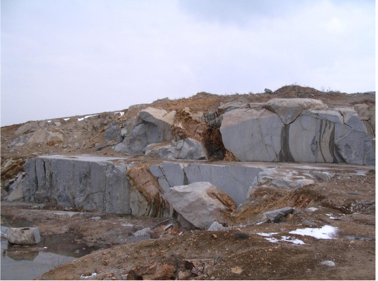
Şekil 49 Jeolojik detay incelemesiz bir granit mermer ocak açılması (Kaman)
