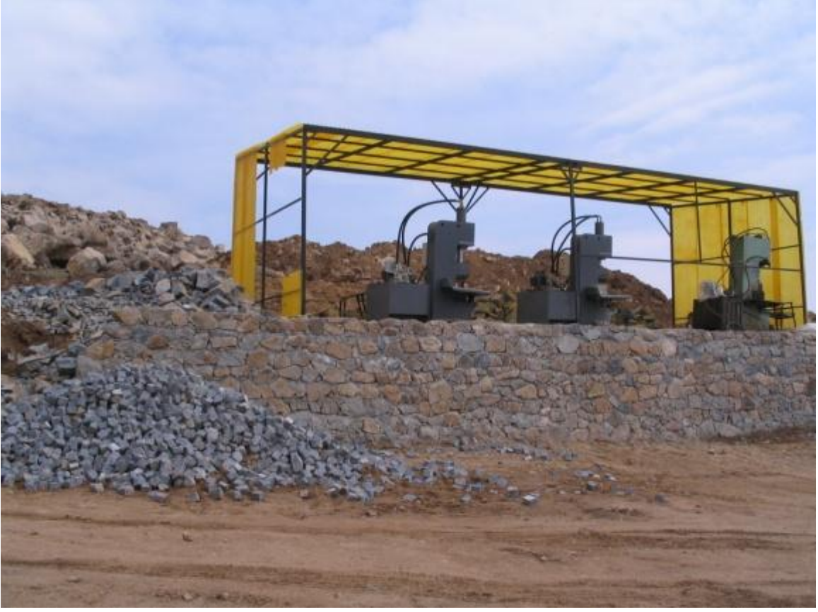
Şekil 54 Atık düzensiz bloklarının değerlendirilmesine bir örnek. Küp taş kesimi.
