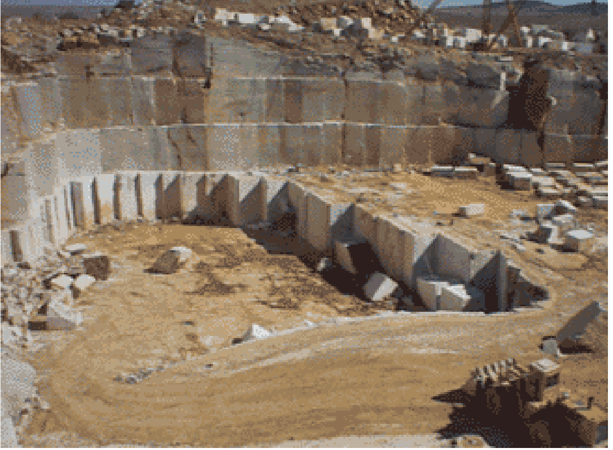
Şekil 9. Çukur şekilli rampa yol sistemli açık ocak doğal taş işletmesi (Koçak Mermer)
