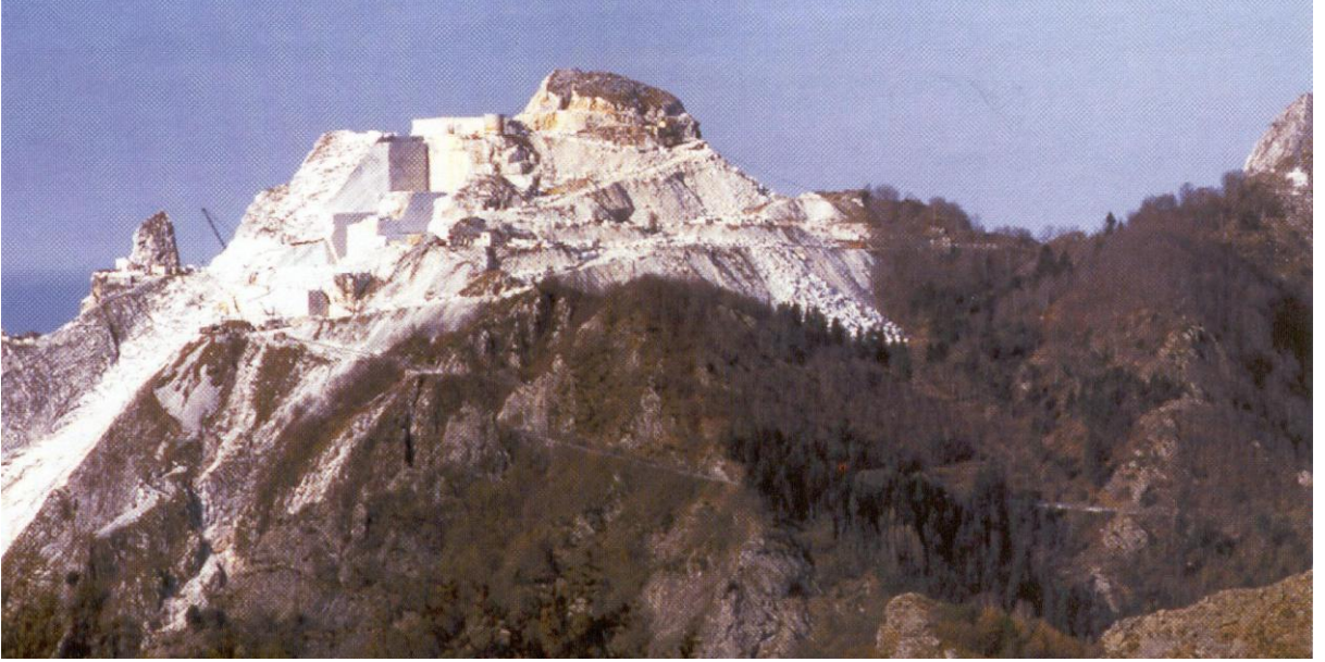
Şekil 30. Yamaç-doruk tepesinden başlayarak tabana doğru oluşturulan basamaklar Ova tipi doğaltaş açık ocak işletmelerinde morfolojik yapıdan dolayı basamaklar inilerek kademeler oluşturulacaktır.
