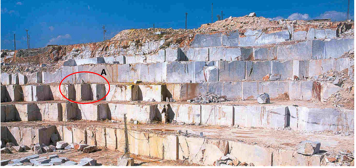
Şekil 32-c. Farklı yönlerde kesimler yapılabilen bir doğal taş ocağı (A bölgesi basamaktaki dilim kesmeler)(DEMMER A.Ş.)
