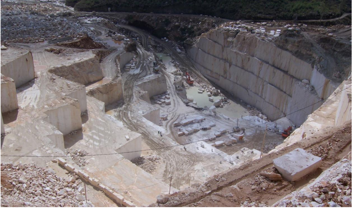
Şekil 2. Yamaç tipi bir doğal taş ocağının üretim sonucu ova tipine dönüşmesi
