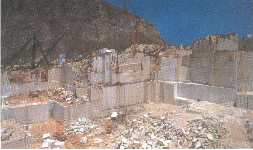
Şekil 6-b. Çok kademeli açık doğal taş ocağı (Sicilya, İtalya)
