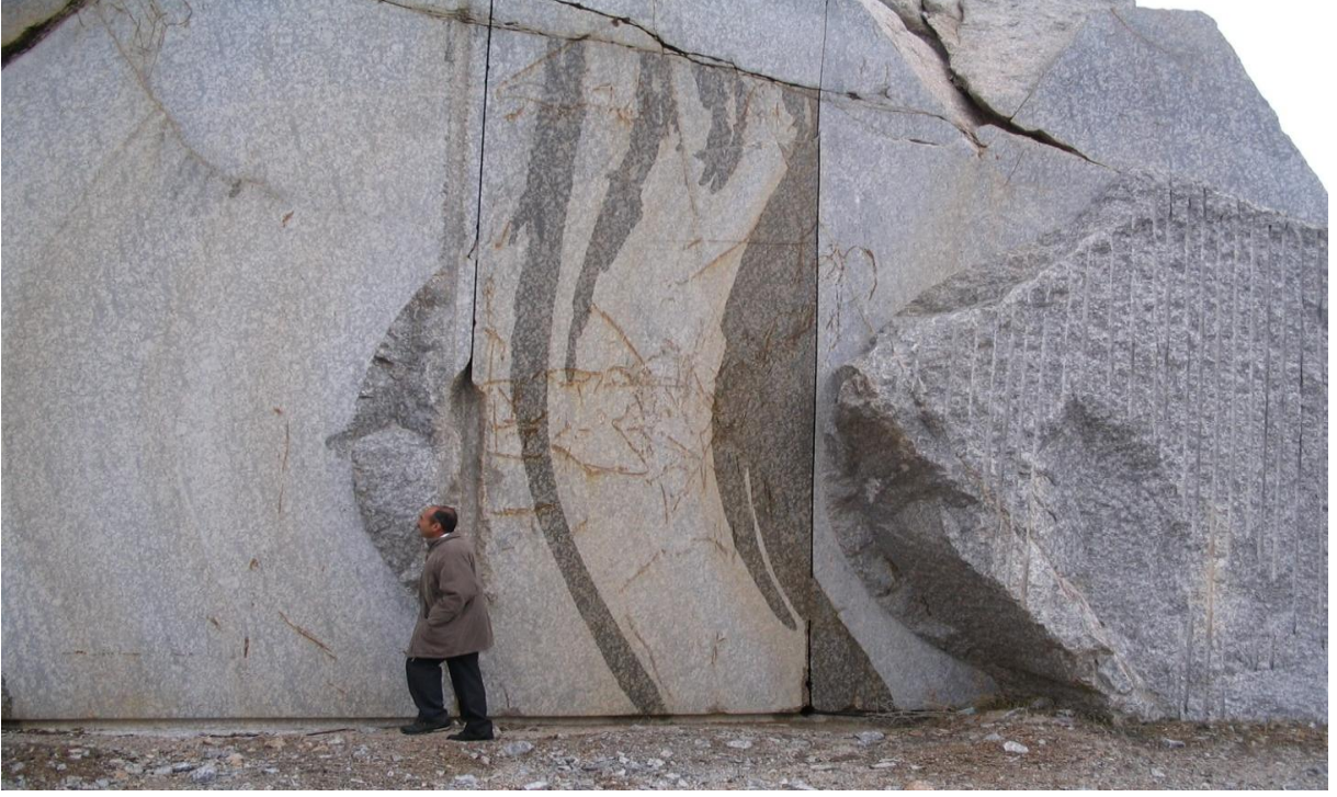
Şekil 51 Yapısal jeoloji etüdü yapılmamış bir granit ocağı ve aynı zamanda teknoloji seçimi hatalı seçilmesi sonucu teknoloji değiştirmesi (Kulaksız, 2000)
