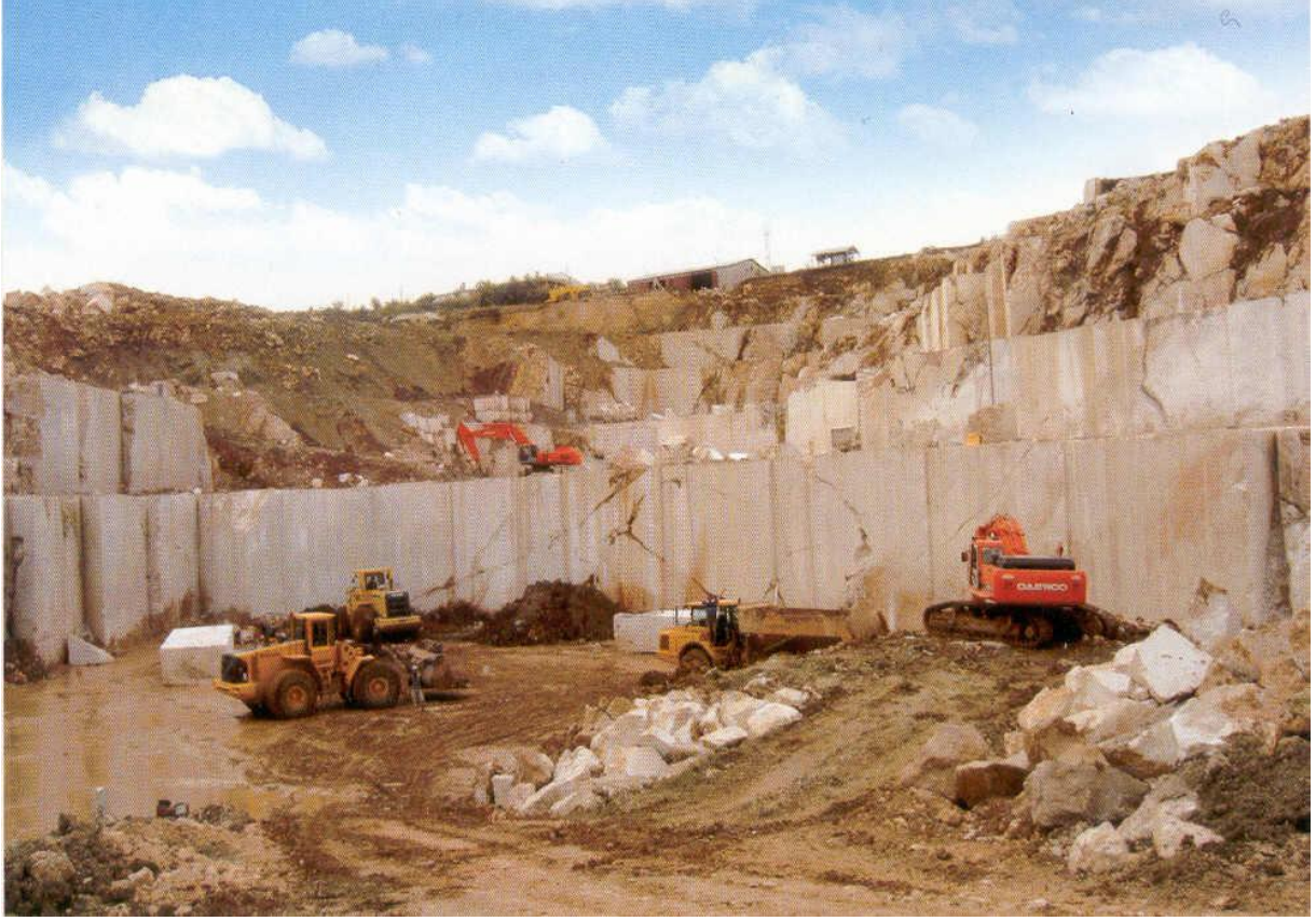
Şekil 8. Ova tipi açık-rampasız doğal taş yatağı (Emmioğlu Mermer)
