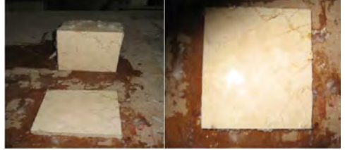
Şekil 14. Epoksi uygulanmış blok ve plakanın görünümü.
