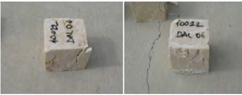
Şekil 18. Epoksi uygulanmamış ve uygulanmış numunenin tek eksenli basınç deneyinden sonraki görünüşleri.
