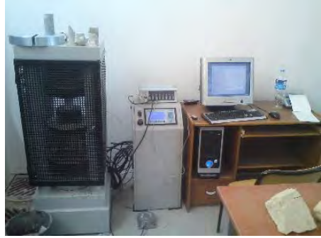
Şekil 3. Deneysel çalışmalarda kullanılan servo kontrollü hidrolik pres
