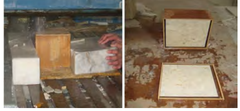
Şekil 13. Polyester ve ahşap hazne uygulanmış numune bloğun kesimi ve kesilen plakanın görünümü.
