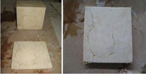
Şekil 15. Epoksi ve file uygulanmış numune blok ve kesilen plakanın görünümü
