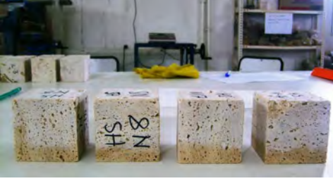
Şekil 1a. Kapiler su emme deneyi sırasında tabandan su almış örneklerin görünümüleri.
