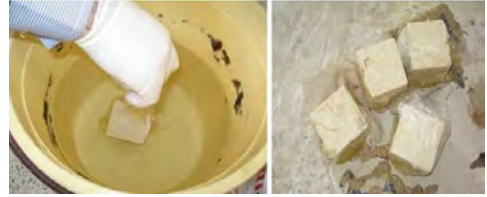
Şekil 17. Epoksi uygulanmış numunenin suya daldırılışı ve Epoksi içerisinde bekletilen numunelerin görünümü.
