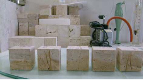
Şekil 1b. Kapiler su emme deneyi sırasında tabandan su almış örneklerin görünümüleri.
