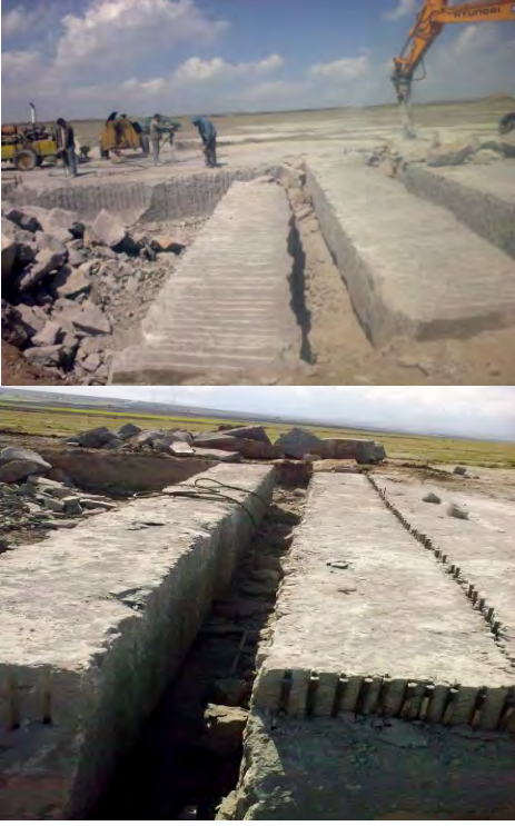
Şekil 9. Delik delme ve çakma kamalar ile bazalt doğaltaş blok üretimi
