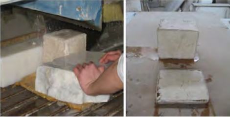
Şekil 12. Alçı ve file ile sağlamlaştırılmış blok kesimi ve kesilen plakanın görünümü.
