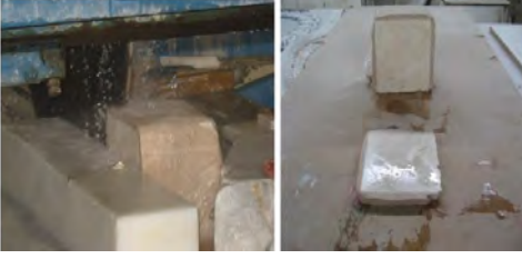
Şekil 11. Alçı ile sağlamlaştırılmış numune blok kesimi ve kesilen plakanın görünümü
