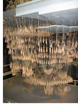
Fotoğraf 6. Guell Kilisesi, Barselona, 1898 ve Antoni Gaudi'nin Guell Kilisesi için tasarladığı katener sistem (Kaynak: http://visit.guidespain.com/_data/_guidespa.in.com/g0_site/1/2814_santa_coloma_de_cervello_c_hurch_of_colonia_guell.jpg , https://qph.ec.quoracdn.net/main-qimgf6eb93aa365795feecff42c95526f1de-c )
