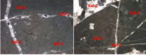
Şekil 1. Bilecik Bejinin Polarizan Mikroskop Altındaki İnce Kesit Görüntüleri (Çift Nikol).
