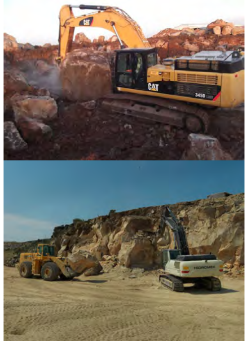
Şekil 11. Süreksizliklerden yararlanarak hidrolik kırıcı ve sökücüler ile bazalt blok üretimi
