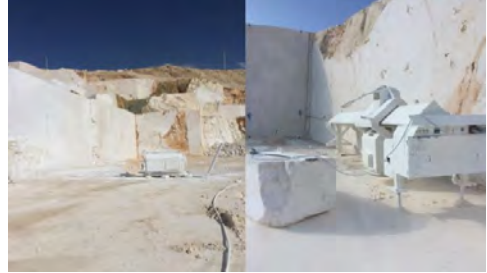
Şekil 4. Söküm yapılacak bölgelerin alt ve yan kesimlerinin yapılması
