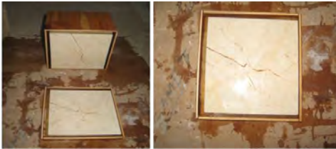
Şekil 16. Epoksi ve ahşap hazne uygulaması ile numune blok ve kesilen plakanın görünümü.
