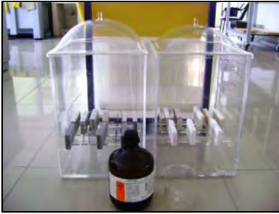
Şekil 2. SO 2 deney kabininin görüntüsü.
