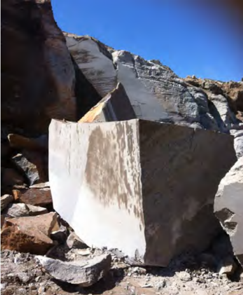
Şekil 10. Bazalt blok üretiminde tel kesme
