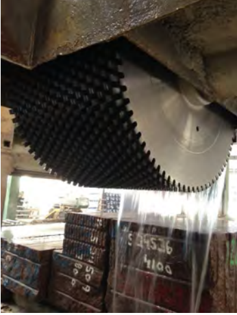
Şekil 1. Çalışmada kullanılan blok kesici ve kesilen bloklardan genel görünüm.
