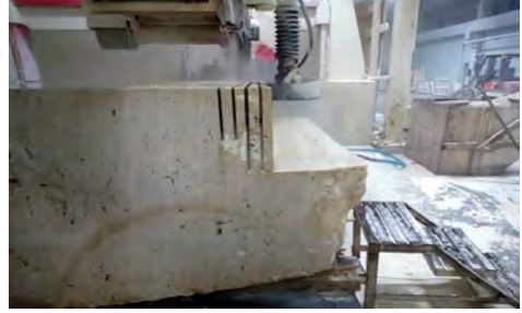
Şekil 3. 28 cm ve 13 cm kesme derinliğinde kesim işlemi
