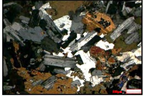
Şekil 4. Demirköy monzograniti genel dokusuna ait XPL görüntüsü
