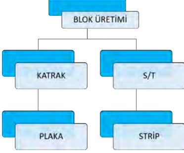
Şekil 1. Ocaktan gelen blokların fabrika üretim aşamaları
