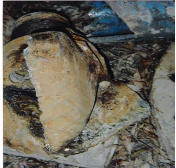
Resim 1. SH-5 kuyusunda kullanılan 11 5/8" kanatlı matkap.
