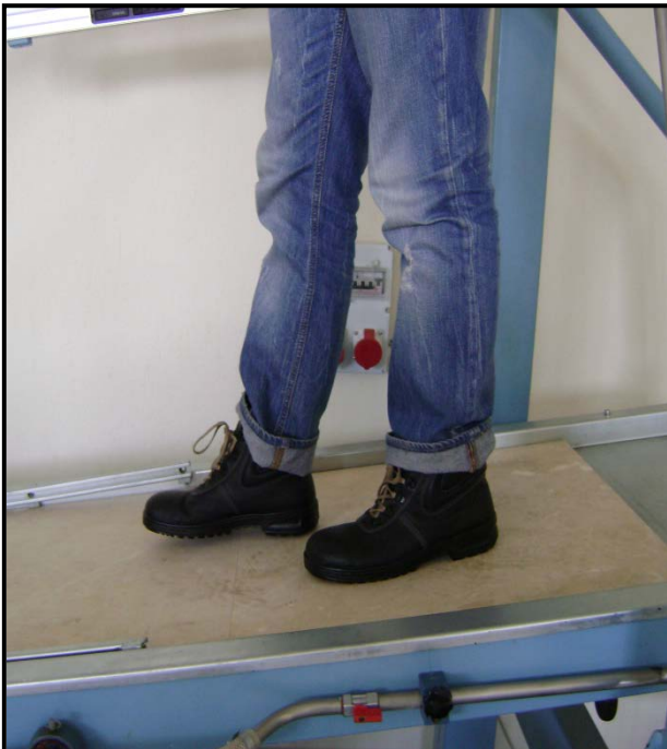
Şekil 2. DIN 51130 standardına göre ölçüm
