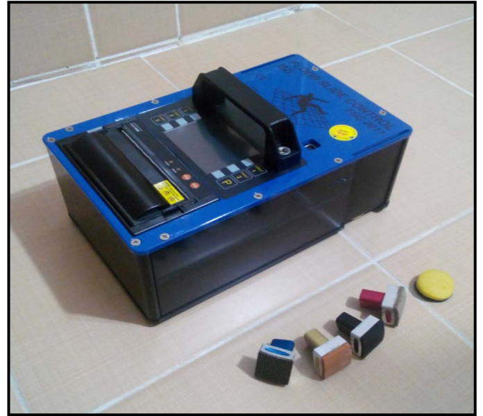
Şekil 5. Mobil sürtünme katsayısı ölçüm test cihazı FSC 2011
