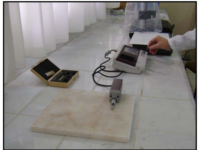
Şekil 6. Yüzey pürüzlülük ölçüm cihazı (MİTUTOYO SJ – 401)
