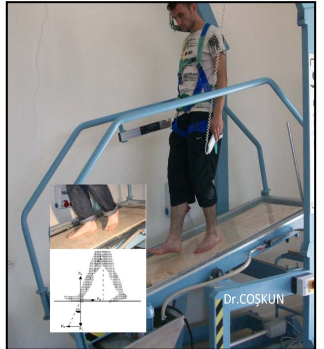
Şekil 1. DIN 51097 standardına göre ölçüm
