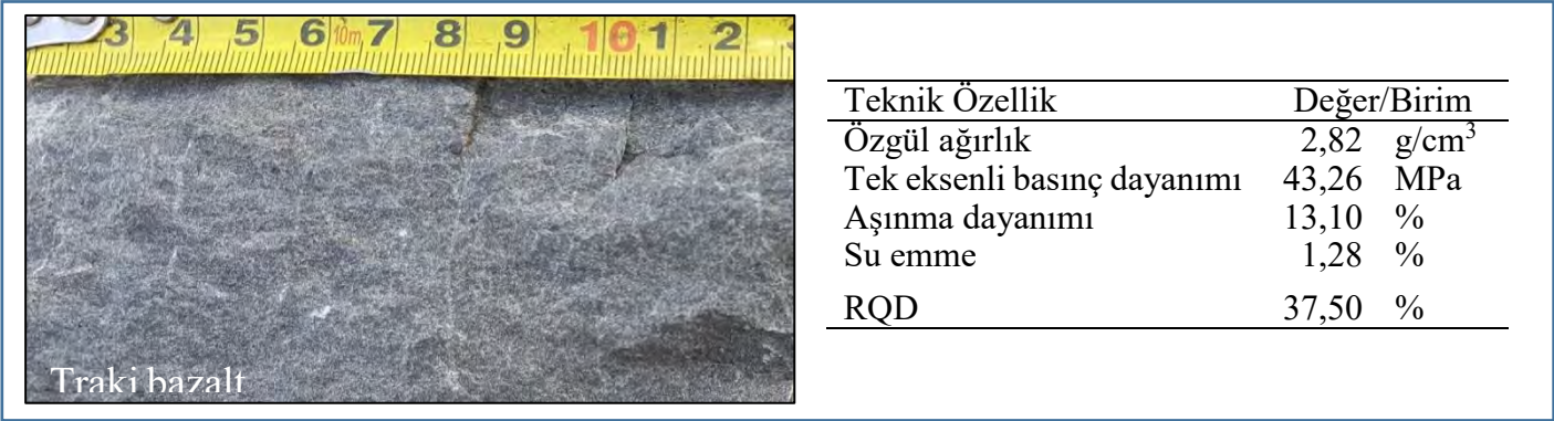
Şekil 2. Çalışma sahasındaki traki bazalt fotoğrafı ve traki bazaltın teknik özellikleri
