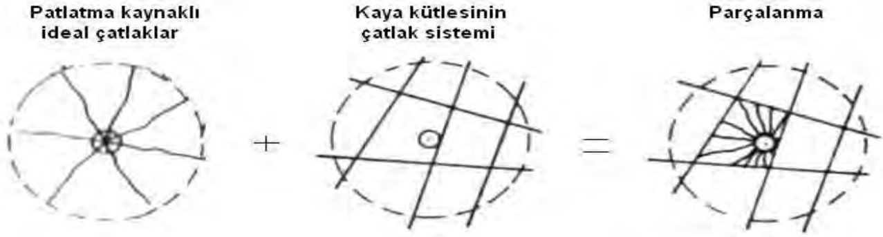
Şekil 4. Çatlaklı yapının parçalanma üzerine etkisi (Hustrulid, 1999).
