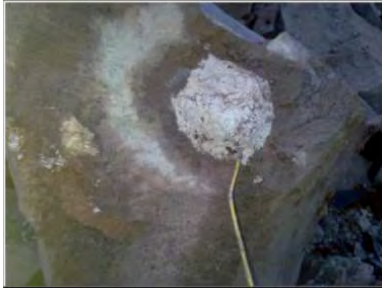
Şekil 1. Patlama sonrası deliği iyice tıkararak yan kayaçla beraber hareket eden alçı sıkılama örneği (Cevizci,2013)
