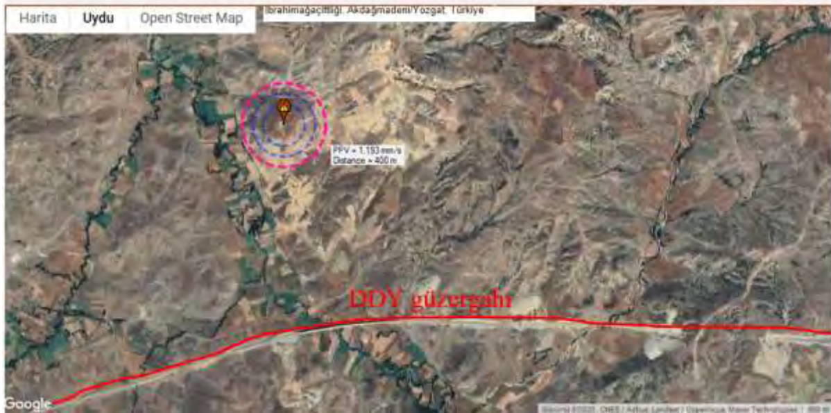
Şekil 7. Açık ocak patlatma bölgesi-1'den yayılacak sismik dalgaların yaratacağı olası titreşimlerin mesafeyle değişimi. Patlatma kaynağından 400m uzaklıkta titreşim değeri 1.193mm/s 'ye düşüyor
