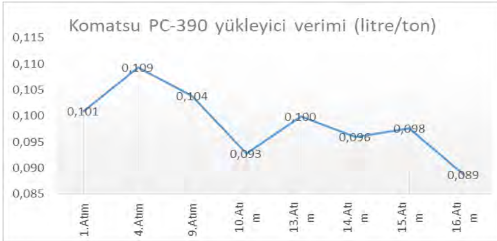
Şekil 7. Komatsu PC 390 ile yüklenen atımların yükleme verimi
