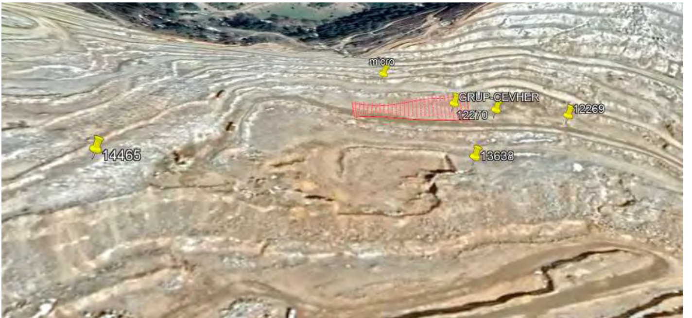
Şekil 7. Cevherde yapılan pilot ve grup patlatmanın ve sismografların yerleri
