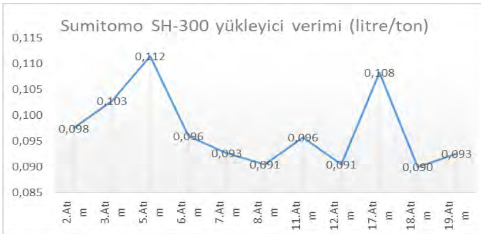
Şekil 8. Sumitomo SH 300 ile yüklenen atımların yükleme verimi
