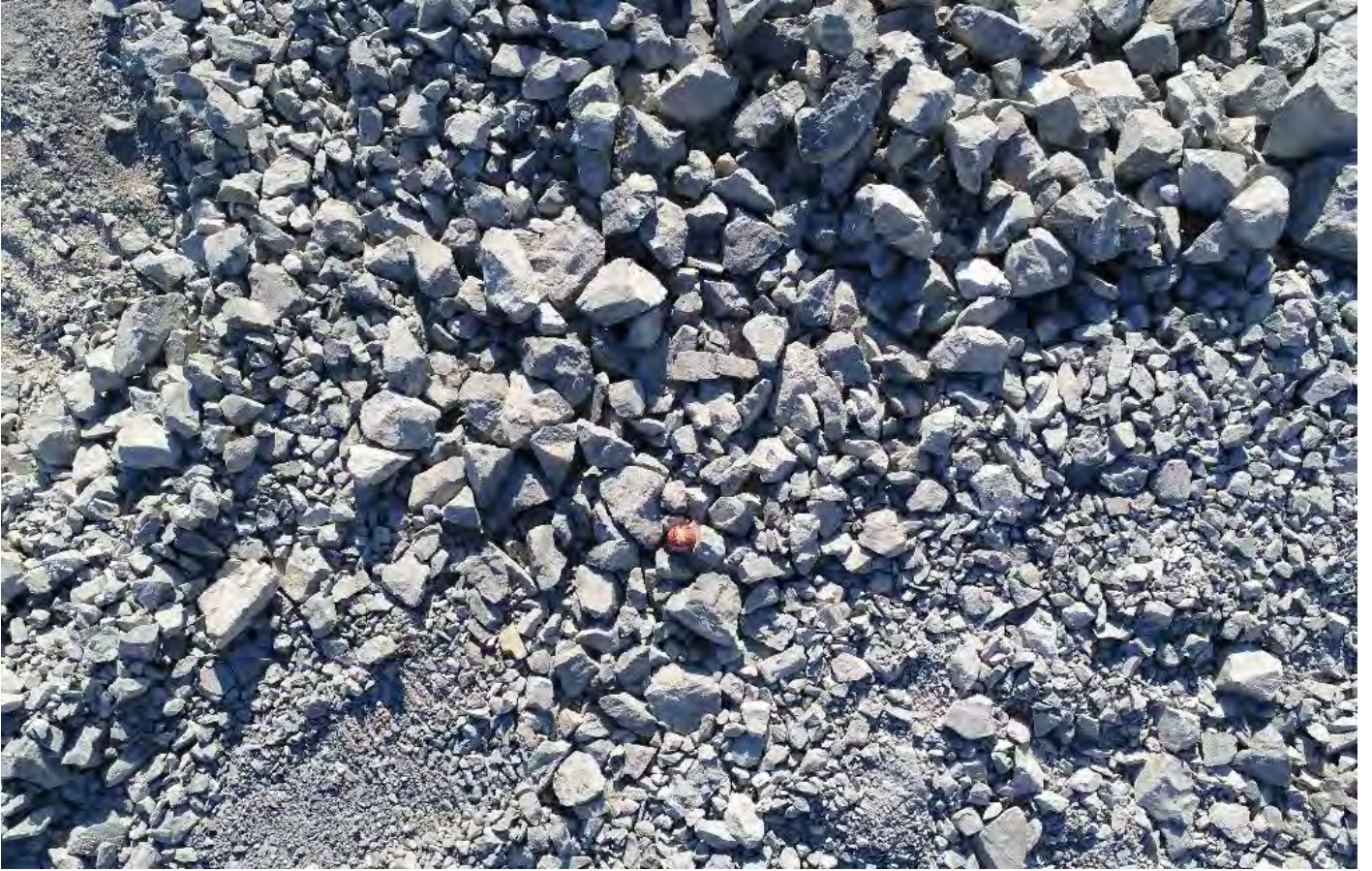
Şekil 14. Tane boyut dağılımı belirlenmesi için kullanılan fotoğraf
