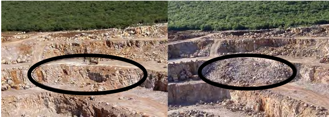
Şekil 5. Patlatma öncesi ve sonrasında delinen bölgeden basamak görünümü (15.Atım).
