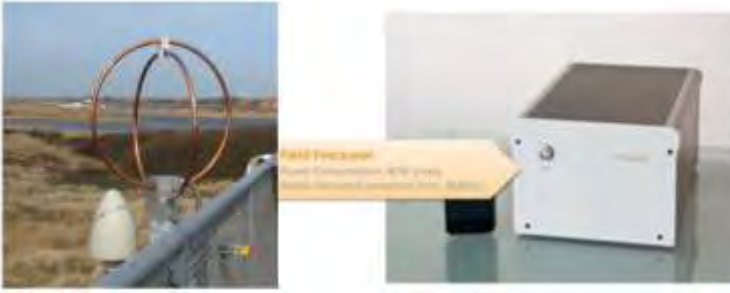
Şekil 2. YTI Anteni ve Saha İşlemcisi
