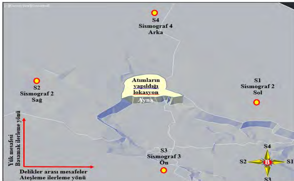
Şekil 3. Çalışma sahasının Autocad modeli ve sismografların konumları
