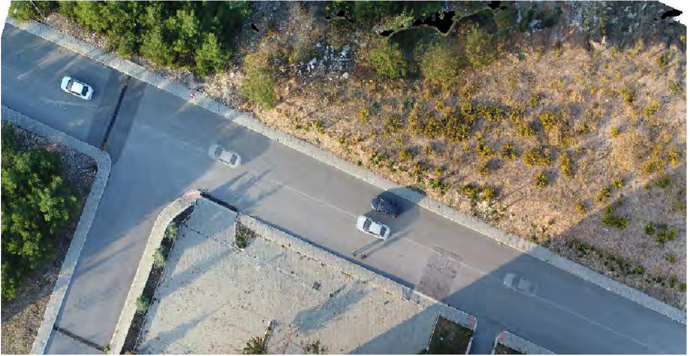
Şekil 2. Modellenek alan içerisinde yer alan hareketli objenin neden olduğu deformasyon (Güler, 2019)
