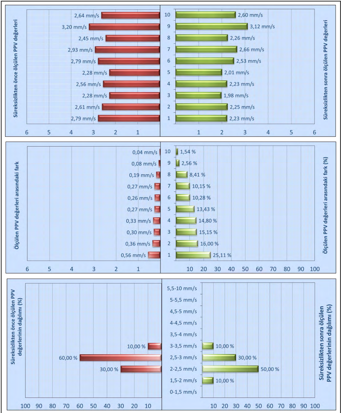
Şekil 8. 8 m aralıklarla süreksizlik oluşturulan çalışma sahasında S3 ve S4 kodlu sismografların kaydettiği PPV değerlerinin dağılımları ve analiz grafikleri (sismograflar arası mesafe 8 metre)
