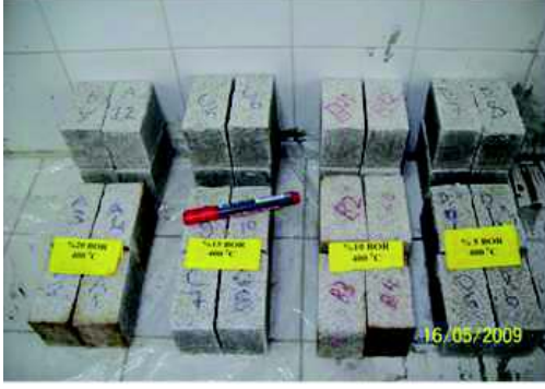
Şekil 3. Farklı oranlarda bor katkısı ile pişirilen tuğlaların görünümü
