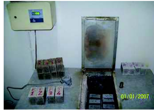
Şekil 2. Farklı karışımlarda üretilen tuğlaların farklı sıcaklıklarda pişirilmesi
