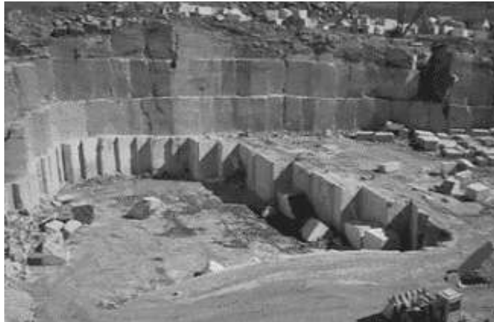
Şekil 10. Çukur şekilli rampa yol sistemli açık ocak doğal taş işletmesi (Koçak Mermer).
