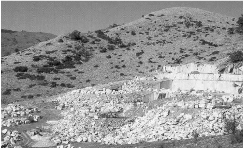
Şekil 26. Yamaç/sırt tabanından başlayarak yükselerek oluşturulan basamaklar.
