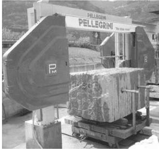
Şekil 47. Doğal taş işletmeciliğinde kullanılan elmas tek telli kesici (monotel).
