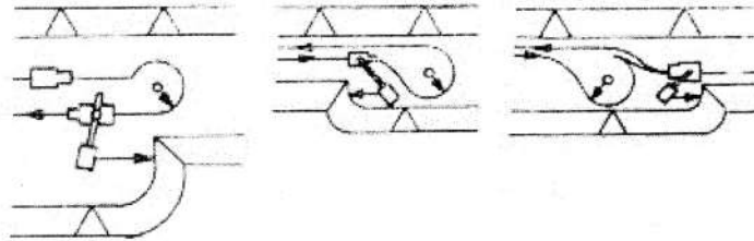
Şekil 18. Kamyonun ekskavatöre yanaşması.
