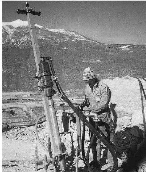
Şekil 52. Doğal taş ocaklarında kullanılan tipik bir delme makinası ve tabancası.
