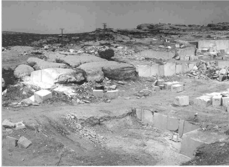
Şekil 7-a. Tek kademeli açık doğal taş ocağı (Toprak Mermer, Diyarbakır).
