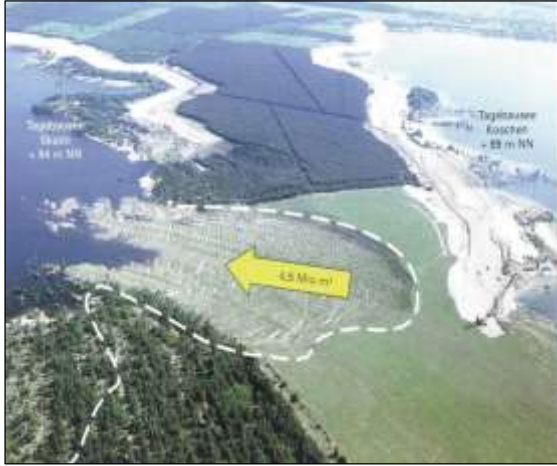
Şekil 1. Koscherikado linyit açık işletme erşev duraysızlığı örneğı (LMBV, 1996)
