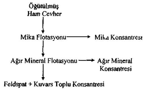
Şekil 6. Flotasyon deneyleri akım şeması.
