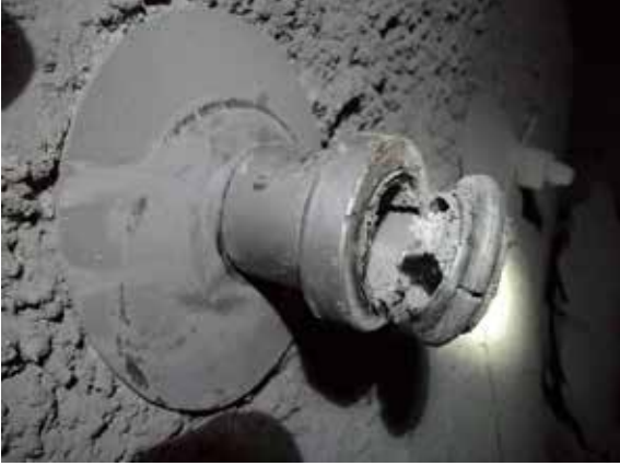
Şekil 4. Kırılmış Split-Set Çeliği
