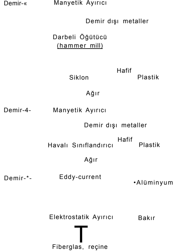
Şekil 2. Atık entegre devre kartlarından fiziksel ayırma yöntemleriyle geri kazanım (Huei-Chia-Dien Co.) (Lee
