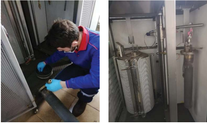
Şekil 6. Numunelerin kok reaktivite cihazına koyulması.
