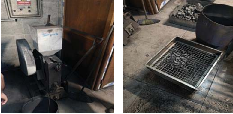
Şekil 4. Kok numunelerinin kırıcıda kırılması ve elenmesi.
