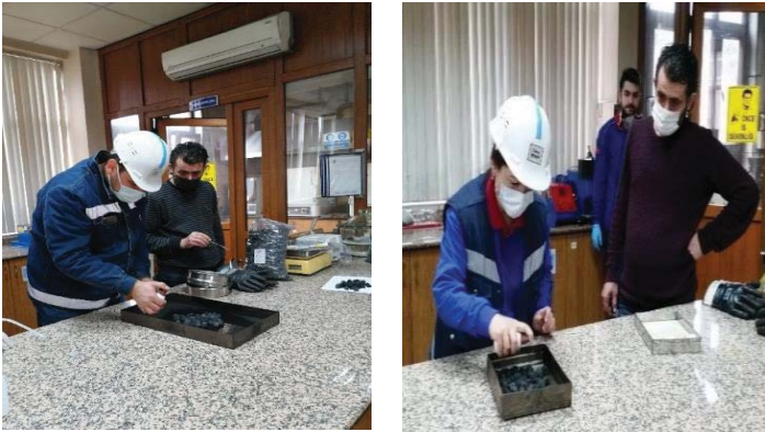
Şekil 5. +19-22.4 mm'lik kok numunesine çözeltilerin püskürtülerek uygulanma anları.
