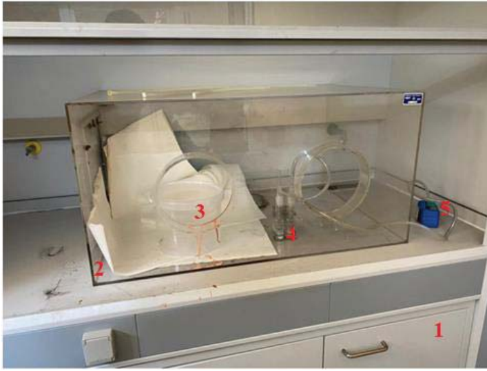
Şekil 1. Reçine ve katalizör arasında açığa çıkan formaldehit gazınının sodyum bisülfid çözeltisine adsorbe edilmesi amacıyla kullanılan ZBEÜ MADEN Köpük Analiz Laboratuvarı'nda kurulu deney düzeneği.
