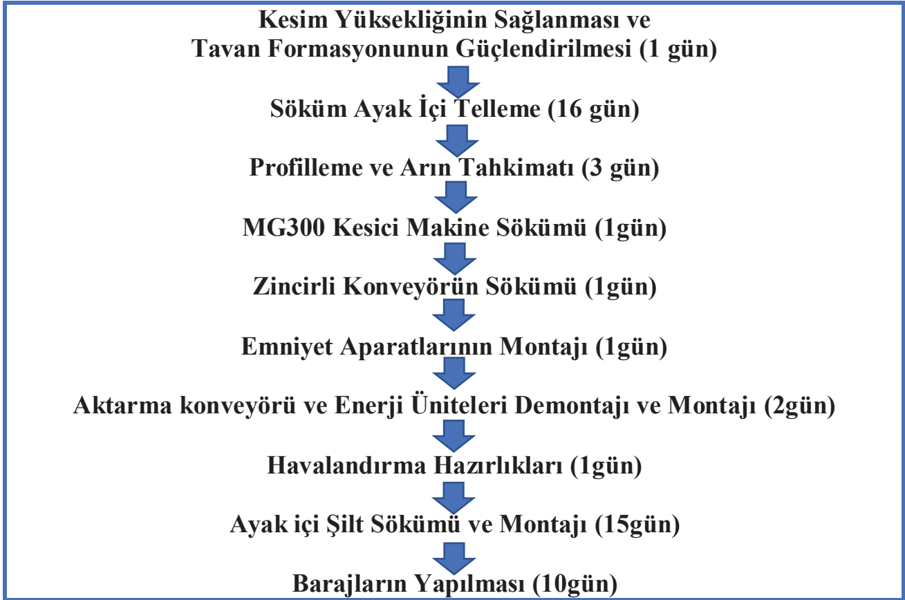
Şekil 1. A01 Panosu söküm ve montaj aşamaları.
