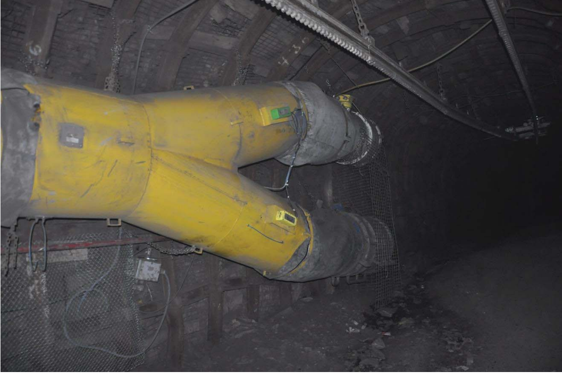
Şekil 12. Yeraltında paralel bağlı fan uygulaması
