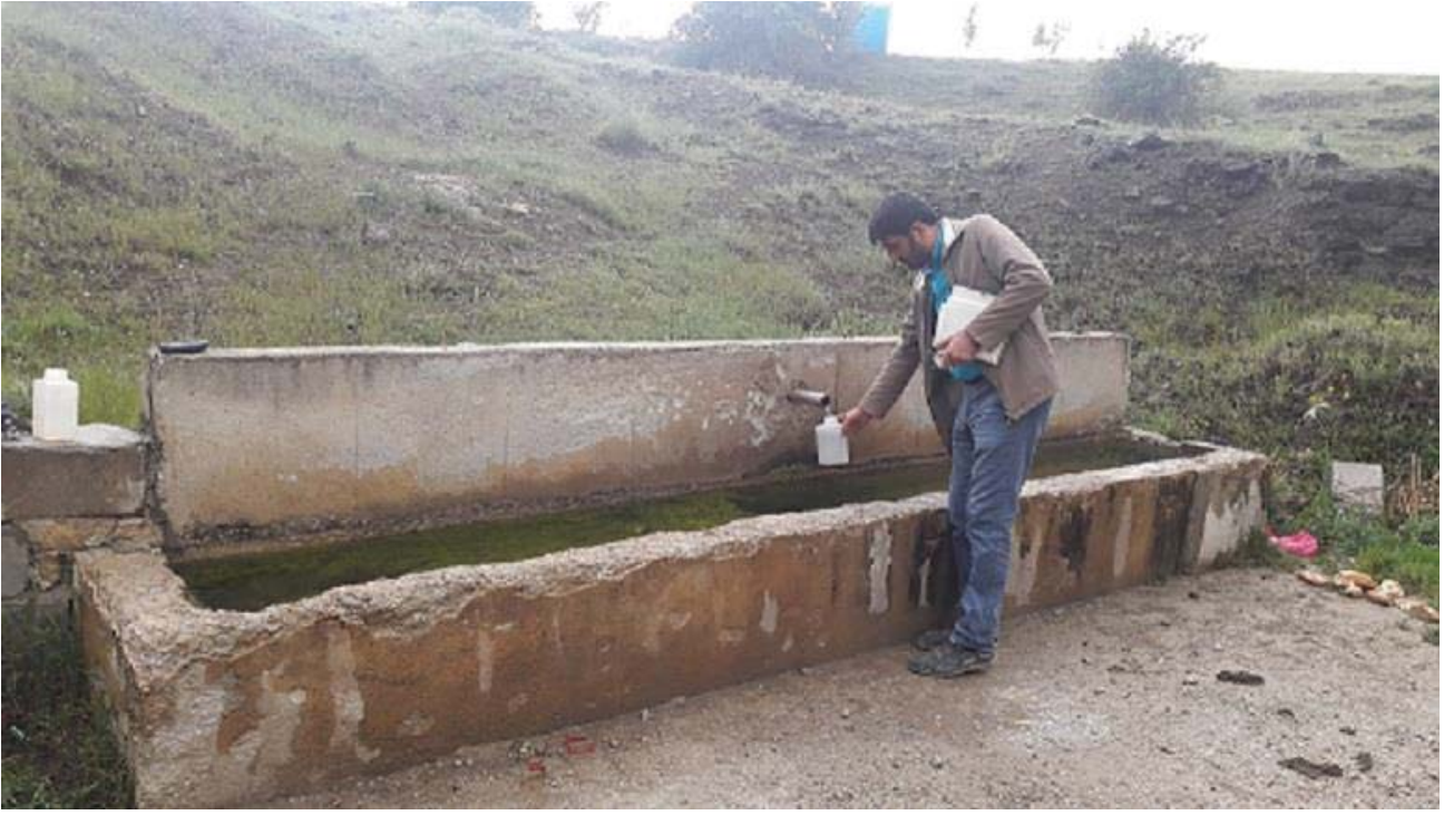
Şekil 6. Doğal bir soğuksu kaynağından ölçekli plastik şişelerle su numunesi alınmasından bir görünüm
