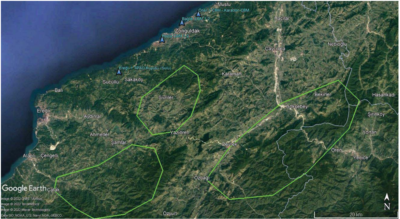
Şekil 6. HEMA A.Ş. tarafından Zonguldak ilinde kömür kökenli doğalgaz üretimi amaçlı delinen kuyuların lokasyonları. Yeşil poligonlar: gravite ve manyetik verilere göre bu çalışmada belirlenen potansiyel kömür kökenli konvansiyonel doğalgaz rezervuarları (bkz. Bölüm 5)
