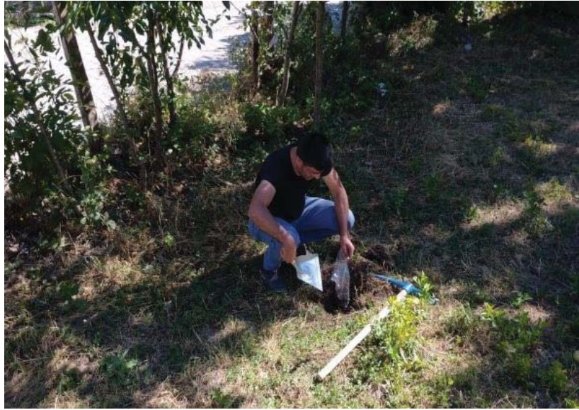
Şekil 7. Kilitli plastik saklama torbası ile topraktan numune alınması
