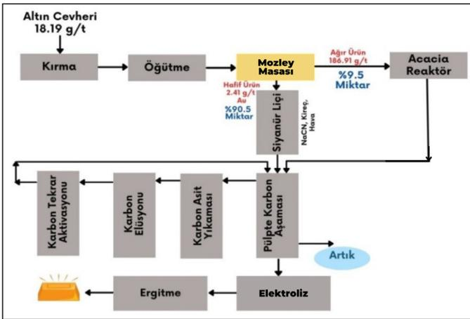
Şekil 16. Alternatif-2 altın üretim proses akım şeması
