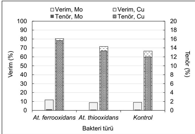
Şekil 8. Bakteriler ile pH 5-6 aralığında 30 dk kıvamlama sonrası flotasyonda kalkopirit konsantrasyonunun tenör-verim değişimi
