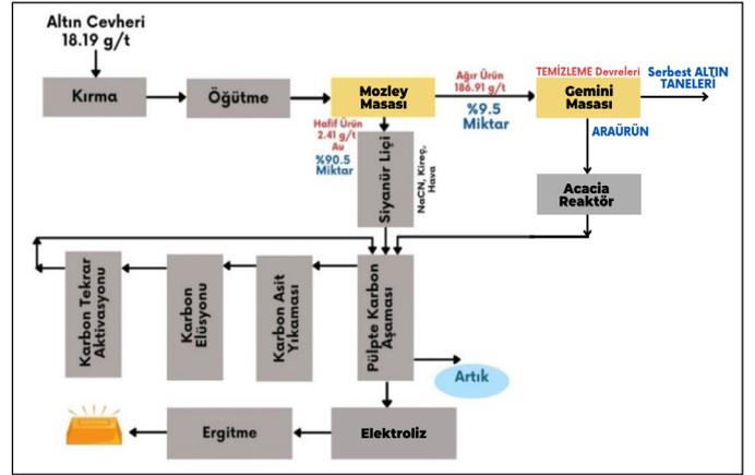
Şekil 17. Alternatif-3 altın üretim proses akım şeması
