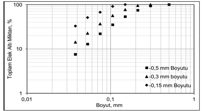
Şekil 9. Öğütme işlemleri sonrası ürünlerin elek analizi sonuçları
