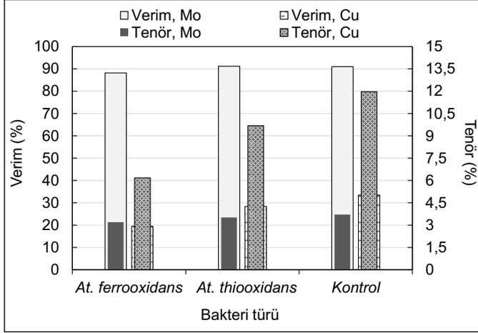
Şekil 7. Bakteriler ile pH 5-6 aralığında 30 dk kıvamlama sonrası flotasyonda molibdenit konsantrasyonunun tenör-verim değişimi
