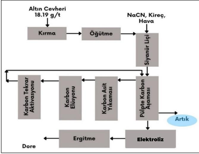
Şekil 15. Alternatif-1 altın üretim proses akım şeması
