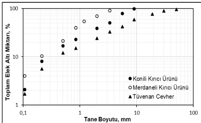
Şekil 8. Kırma işlemleri sonrası ürünlerin elek analizi sonuçları
